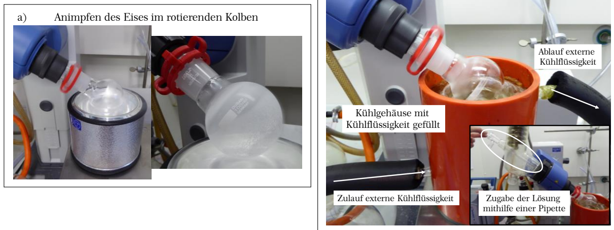
Abbildung A.11: Darstellungen der drei Schritte bei der Eisfilmaufreinigung (ISP). a) Durch Rotieren eines mit wenigen Millilitern Wasser gefüllten Kolbens in flüssigem Stickstoff friert eine dünne Eisschicht an der inneren Kolbenwand an. b) Anschließend wird der Kolben mit dem Impfeis in einem mit einem externen Kühlbad temperierten Vorratsgefäß, das selbst mit einer Kühlflüssigkeit gefüllt ist, gerührt. Die Zugabe der aufzureinigenden Lösung erfolgt über den anhängenden Kühler mit einer längeren Messpipette (unten rechts).
