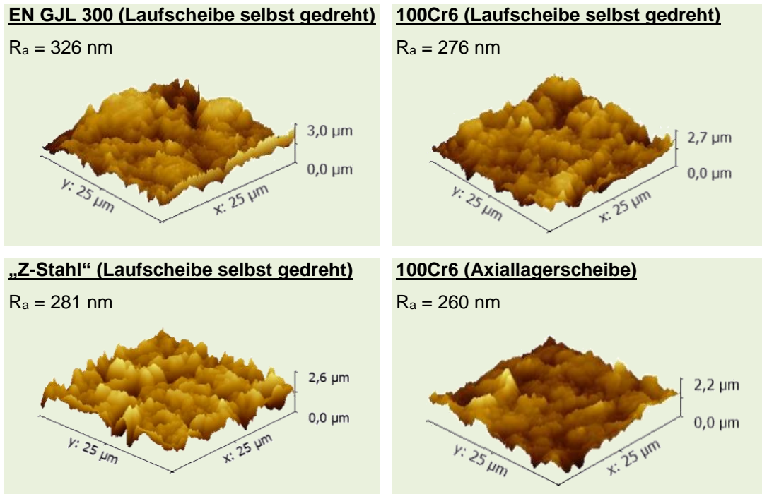
Abbildung 35: AFM Topografie der Scheiben nach dem Läppvorgang
