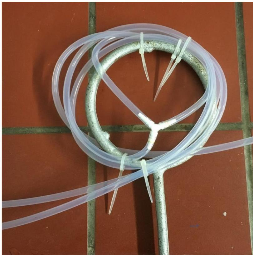
**Abbildung 2–39:** Aufbau für die Reaktion im *Flow-Setup* mit den beiden Zuläufen auf der linken Seite und dem Ablauf auf der rechten Seite. In der Mitte ist der Schlauchverbinder als Mischungseinheit zu erkennen.
