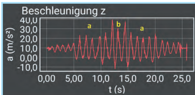
Abb. 9. Simulation markanter Phasen der Fahrt mit dem Rocket durch Pendelbewegung eines Smartphones am ausgestreckten Arm (App phyphox). a: Auslenkung bis 90^\circ , b: Auslenkung weit über 90^\circ .
