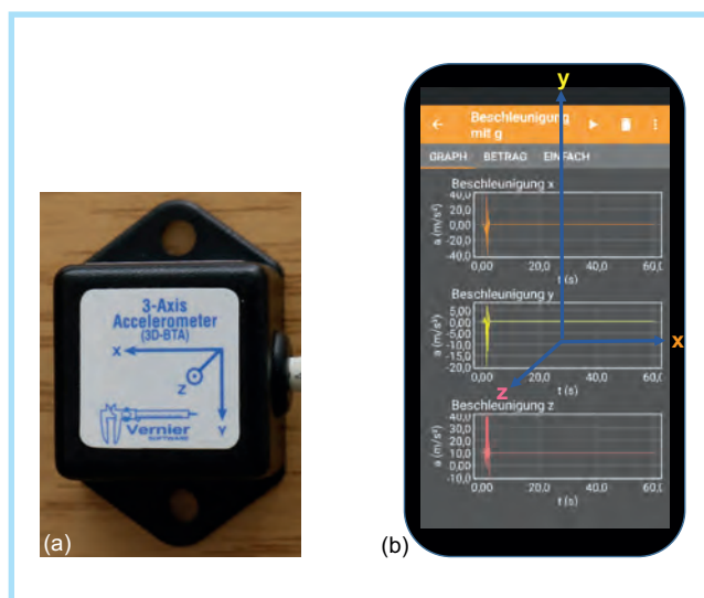
Abb. 2. Lage des Koordinatensystems bei Beschleunigungsmessungen. (a) Beispiel eines Beschleunigungssensors; (b) Smartphone. Die dargestellte Messung (aufgenommen mit der App phyphox) zeigt die Beschleunigungswerte eines – nach einer anfänglichen Bewegung – ruhig auf dem Tisch liegenden Smartphones.
