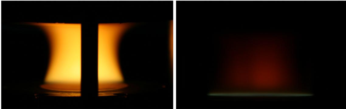
**Abbildung 9.1.:** Fotos der stark rußenden C3-Flamme (links) und der Vergleichsflamme (rechts). Als Aufnahmeeinstellungen waren eingestellt: Blendenzahl: F/2.8, Belichtungszahl 1/100 s. Die ISO-Empfindlichkeit bei der C3-Flamme betrug ISO-100, bei der Vergleichsflamme ISO-200. Beim Vergleich der Intensität der beiden Fotos muss beim rechten Foto eine Erhöhung um Faktor 2 berücksichtigt werden.
