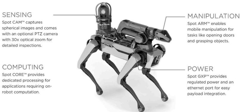
Abbildung 3.3: Der mobile Roboter Spot [O13]
