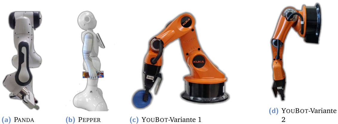
Abb. 3.5.: Initialhaltung der Roboter, nachdem das Objekt gegriffen wurde und bevor es gereicht wird. Da der carrying angle bei dem YOUNOT nicht erreicht werden kann, sind dessen Varianten in der Frontansicht dargestellt.
