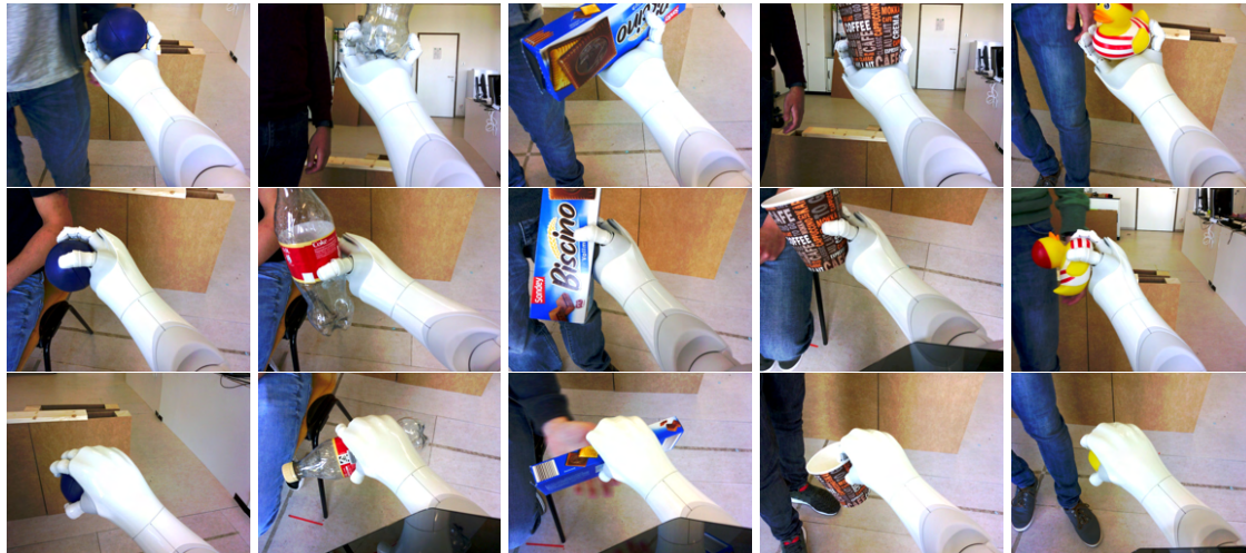
Abb. 3.19.: Bilder der gewählten Griffe aus der Sicht des Roboters. Von links nach rechts die verschiedenen Objekte: Ball, Flasche, Schachtel, Becher und Spielzeug. Von oben nach unten die drei Cluster.
