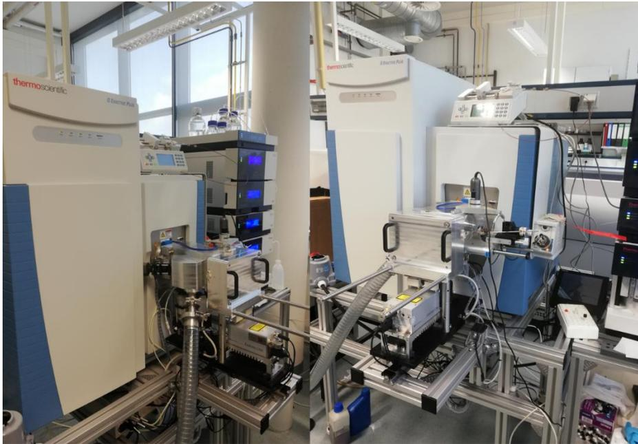
**Abbildung 39** Umgebaute *funnel*-Konstruktion der Firma Spectrograph LL für eine duale ESI/MALDI-Quelle der Q Exactive Plus Orbitrap-MS am CeBiTec in Bielefeld.
