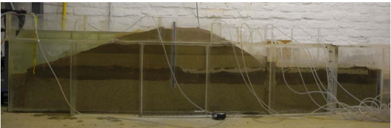
Abb. 11: Kleinmaßstäbliches Dammmodell im Maßstab 1:10 zur Untersuchung der Wirkungsweise von Druckentlastungsdrainagen.
