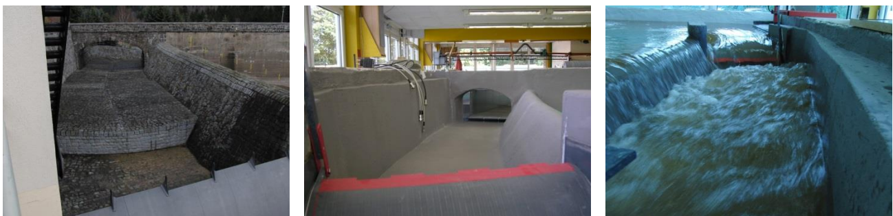
Abb. 2: HWE der Talsperre Malter 2014 (links); vergleichmäßigt Sohlgefälle in der SaR im hydraulischen Modell (Mitte); Hochwasserabführung SaR im hydraulischen Modell (rechts)
