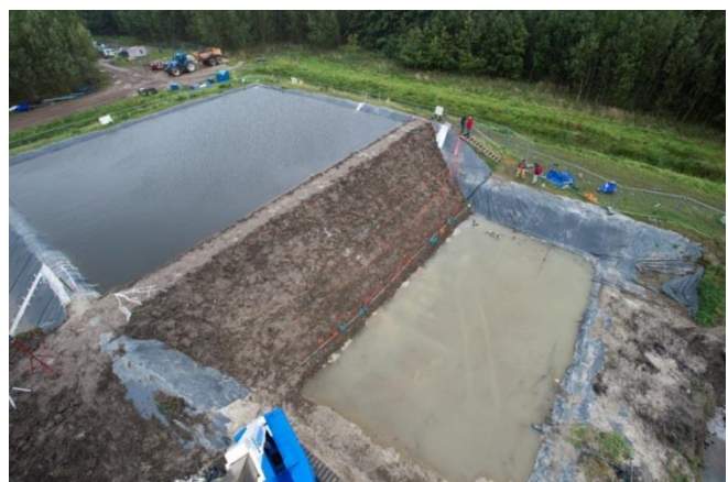
Abb. 5: Einbau des Geotextils in Sandschicht, vor Aufbau des Kleideichs (links) und Blick auf den Deich bei vollständig gefülltem Bassin am Ende des Versuchs. An der unterstromigen Seite sind nur wenige Sandkrater zu erkennen.
