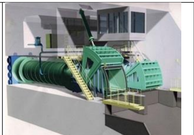
Abb. 12: Tomata Talsperre Anlagenbestandteile der Zwischenauslässe ( www.cgr.mlit.go.jp )
