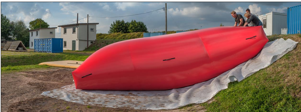
Abb. 6: TÜV-Zertifizierungstest des Flutschutz-Auflastfilters am Übungsdeich der THW-Bundesschule Hoya im September 2012
