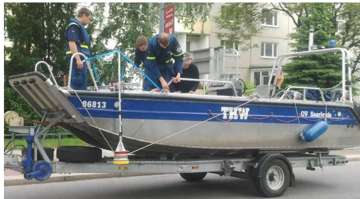
Abb. 7: Mehrzweckboot auf Trailer mit montiertem ADCP-Messkopf auf Backbordseite (Foto: H. Martin, aus: STAMM ET AL., 2013)
