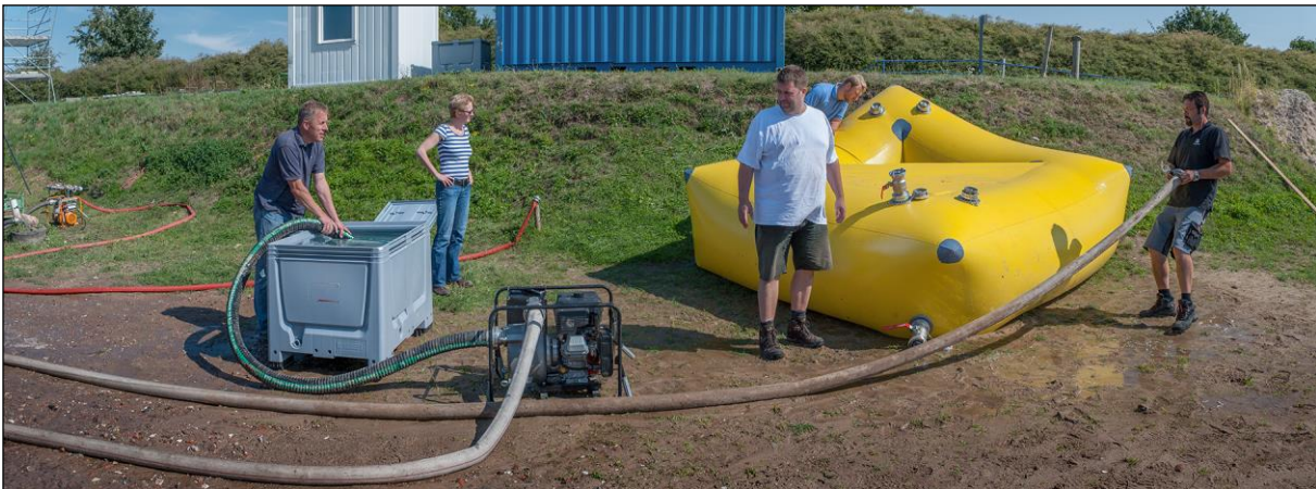
Abb. 5: TÜV-Zertifizierungstest der Flutschutz-Quellkade am Übungsdeich der THW-Bundesschule Hoya
