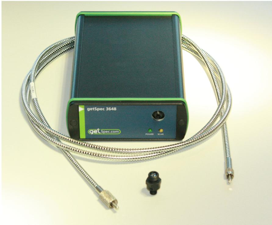
Abbildung 5.2: Spektrometer getSpec 3648 zur Aufzeichnung und Analyse des Plasmaleuchtens
