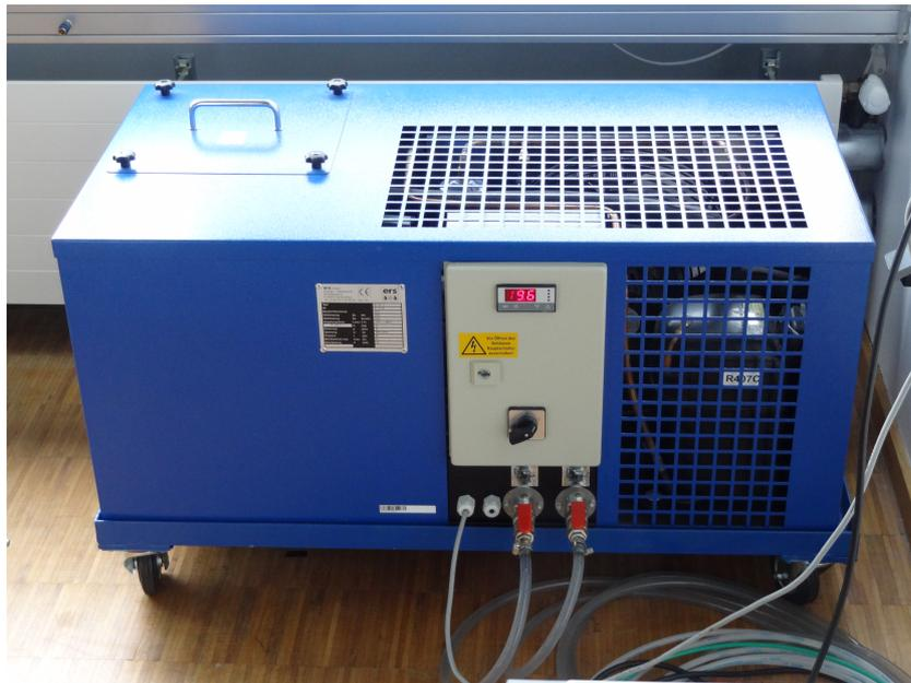
Abbildung 4.27: Externe Kühlung zum Laser RoFin Sinar SC x10
