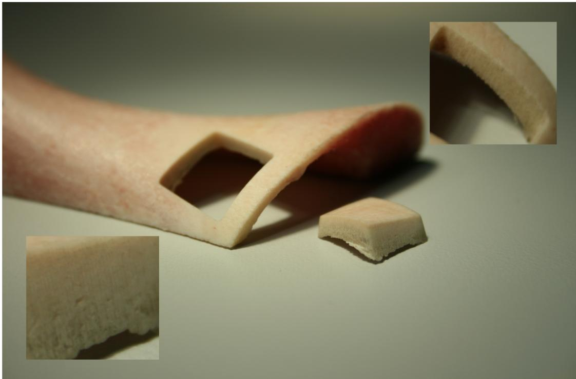
Abbildung 3.8: Beispiel eines Schnittergebnisses einer Laserosteotomie mit vorher definierter Geometrie an Schweineknöchel
