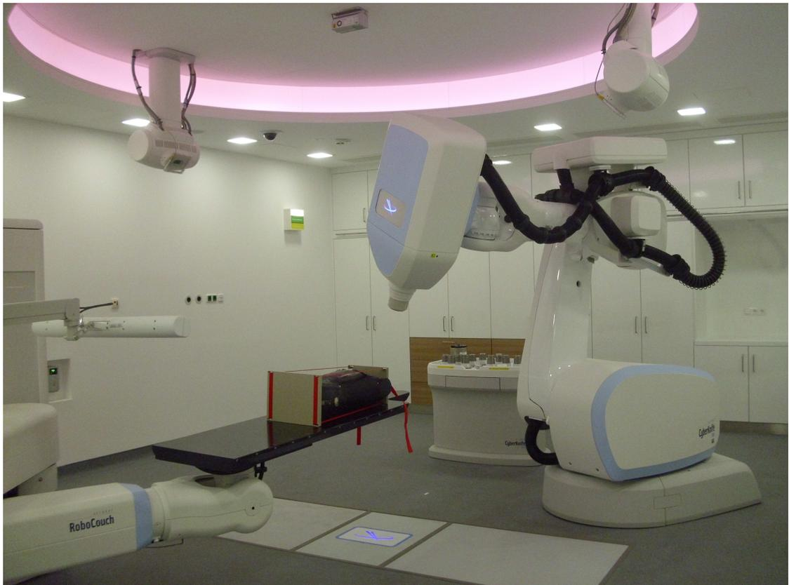
Abbildung 2.1: Bestrahlungssystem CyberKnife des Herstellers ACCURAY
