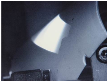
Abbildung 3.20: Erster Strahl in der Experimentierhütte. Gezeigt ist das Strahlprofil innerhalb des Monochromators auf einem Fluoreszenzpapier.
