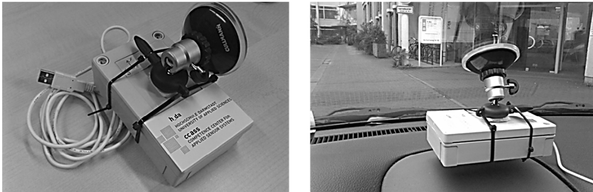
Abbildung 11.2: Funktionsmuster einer Inertialeinheit mit einem GPS-Referenzsystem zur abschattungs-freien Objektverfolgung in der Distributionslogistik
