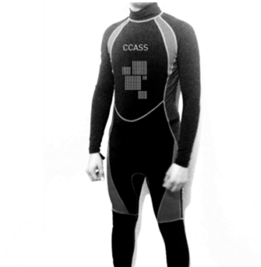
Abbildung 11.1: Referenzloser Multisensoranzug aus low-cost Inertialeinheiten zur dreidimensionalen Bewegungserkennung (Foto: CCASS Darmstadt, Berezowski et al.)
