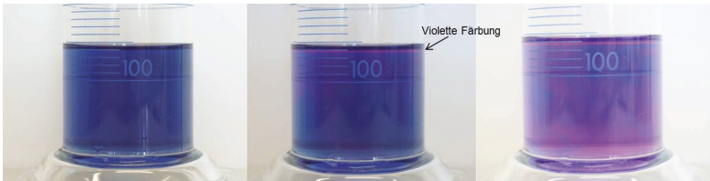
Abb. 4: Eintrag von Kohlenstoffdioxid über die Luft in das Wasser. Zunächst wird nur ein hauchdünner violetter Streifen an der Oberfläche sichtbar, nach einigen Minuten durchdringt die violette Färbung die gesamte Lösung.
