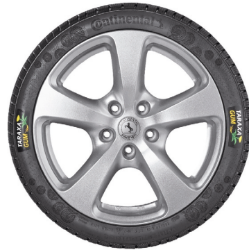
Abb. 2: Taraxagum-Reifen mit einem hohen Anteil Löwenzahnkautschuk (Continental Reifen Deutschland GmbH 2015)
