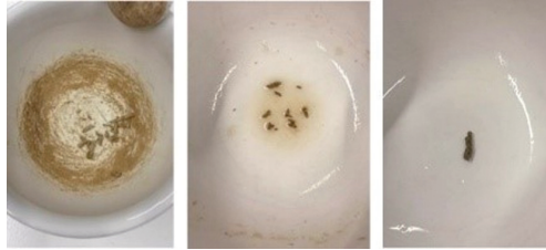
Abb. 4: Kautschukgewinnung durch Mörsern getrockneter Wurzeln
