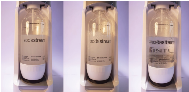
Abb. 5: Eine Muschelsuspension wird im Sodastream durch die Zufuhr von Kohlenstoffdioxid aufgeklärt.
