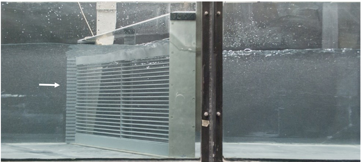
Abb. 2: Horizontaler Fischleitreechen im Laborversuch ( \alpha = 45^\circ , b = 0.01 m, l = 0.025 m, Sohl- und Tauchleitwand mit Verbauungsgraden von jeweils 10 % der Rechenfläche) (Maager, 2016)
