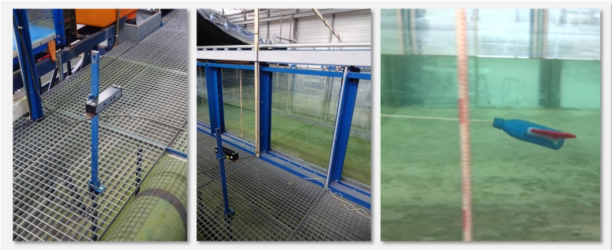
Abb. 4: Erste Tests zum Fischtrackingsystem mit einem Fischdummy (Flasche) im wasserbaulichen Forschungslabor der TU Darmstadt
