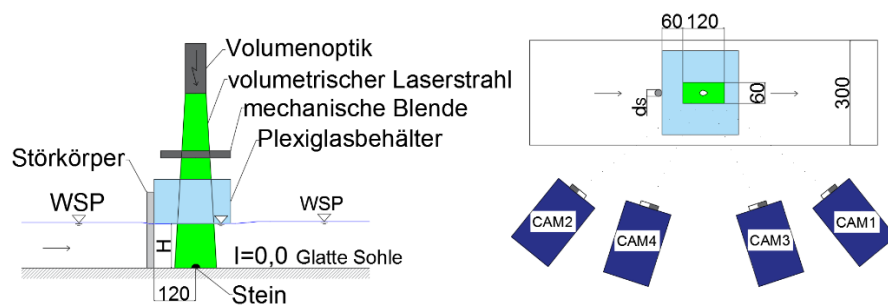
Abb. 1: Versuchsaufbau und Darstellung des Messsystems (linkes Bild – Frontansicht; rechtes Bild – Draufsicht)
