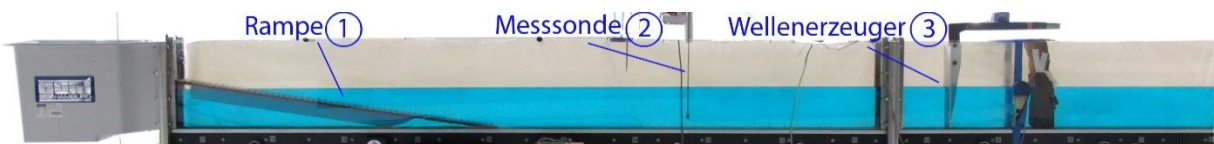
Abb. 1: Versuchsaufbau mit Rampe, Messsonde und Wellenerzeuger
