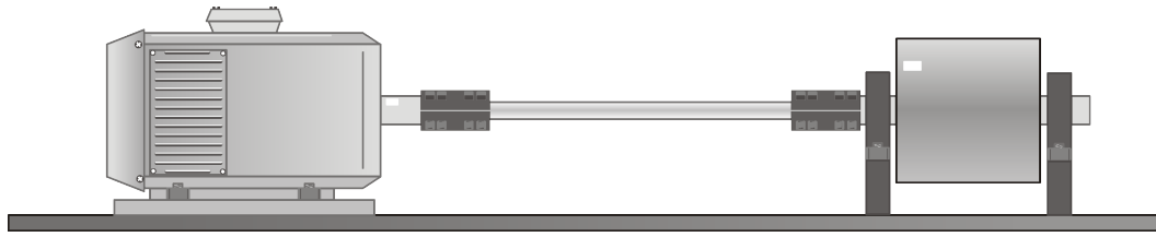
Bild 2.1: Darstellung eines Zwei-Massen-Systems
