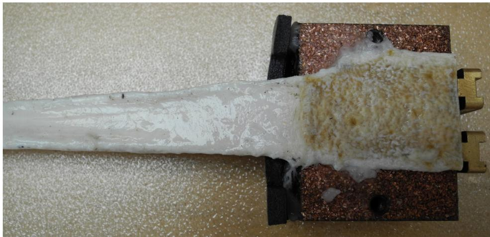
*Abbildung 5.1: Angehaftete OBS an Klemmbacke 2 nach Beendigung des biomechanischen Versuchs und Demontage der Einspannung*
