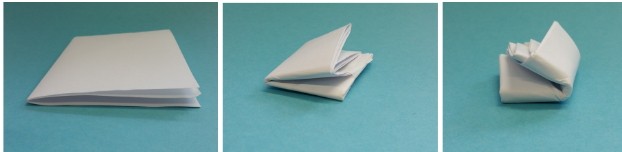
Abbildung 3.2: Diese Abbildungen zeigen deutlich die Verdopplung der Dicke nach jeder Faltung. Zu sehen sind 2, 5 und 6 Faltungen des Papiers. Verwendet wurde hier 80g-Papier der Größe DIN A4, wodurch eine siebte Faltung nicht mehr möglich war.
