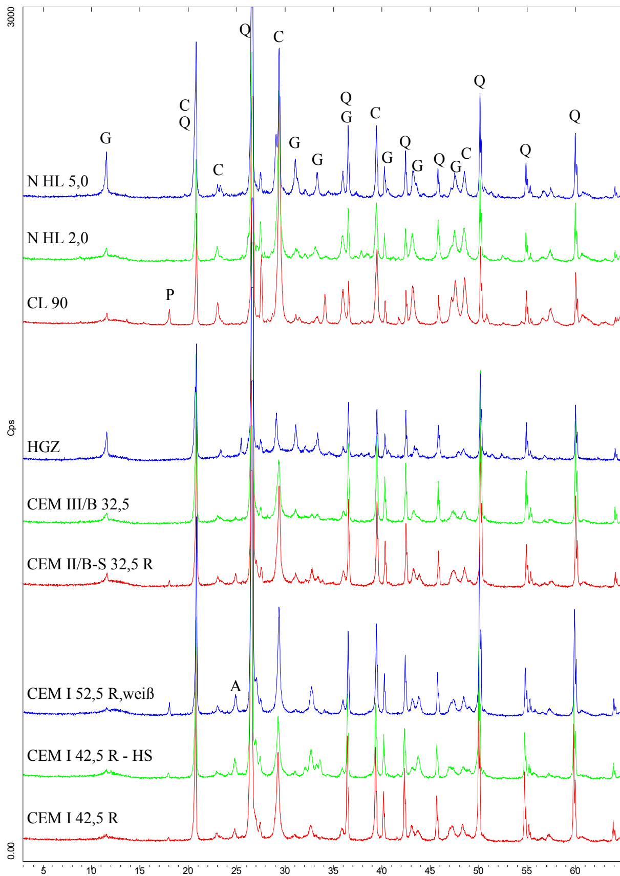
Abbildung 7.1: Röntgenbeugungsdiagramme der T-100 0-2 mm Proben nach 720d
