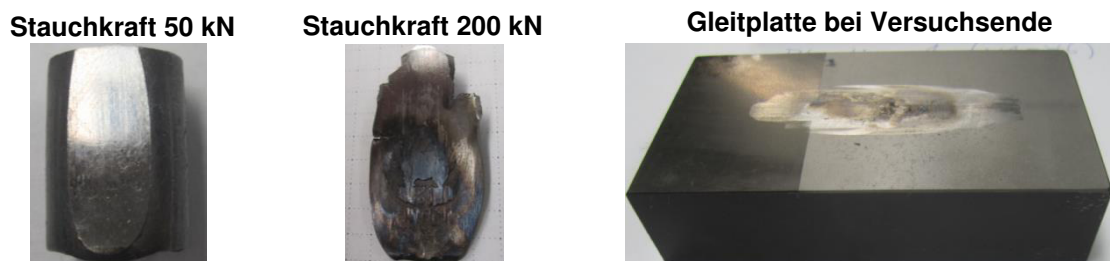
Bild 4.26: Proben bei unterschiedlichen Stauchkräften nach einem Gleitweg von 8 mm
