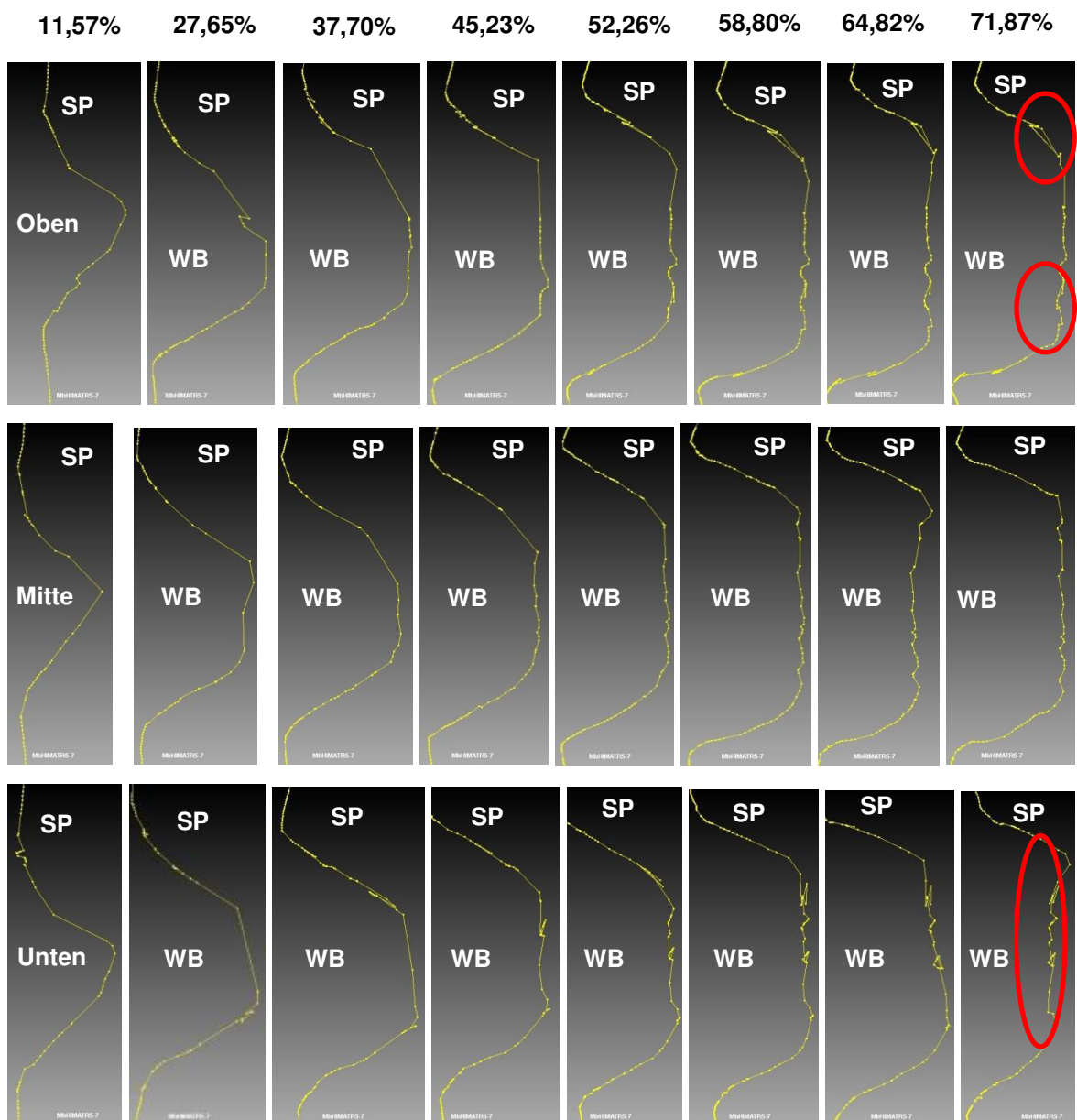
Bild 6.14: Fließlinien im oberen, mittleren und unteren Bereich der Spindel in Abhängigkeit von der Prozesszeit (in % des Gesamtprozesses; WB: Walzbacke, SP: Spindel)
