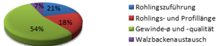
Bild 3.1: Rüstzeitverteilung beim Gewindewalzen [Rot00]
