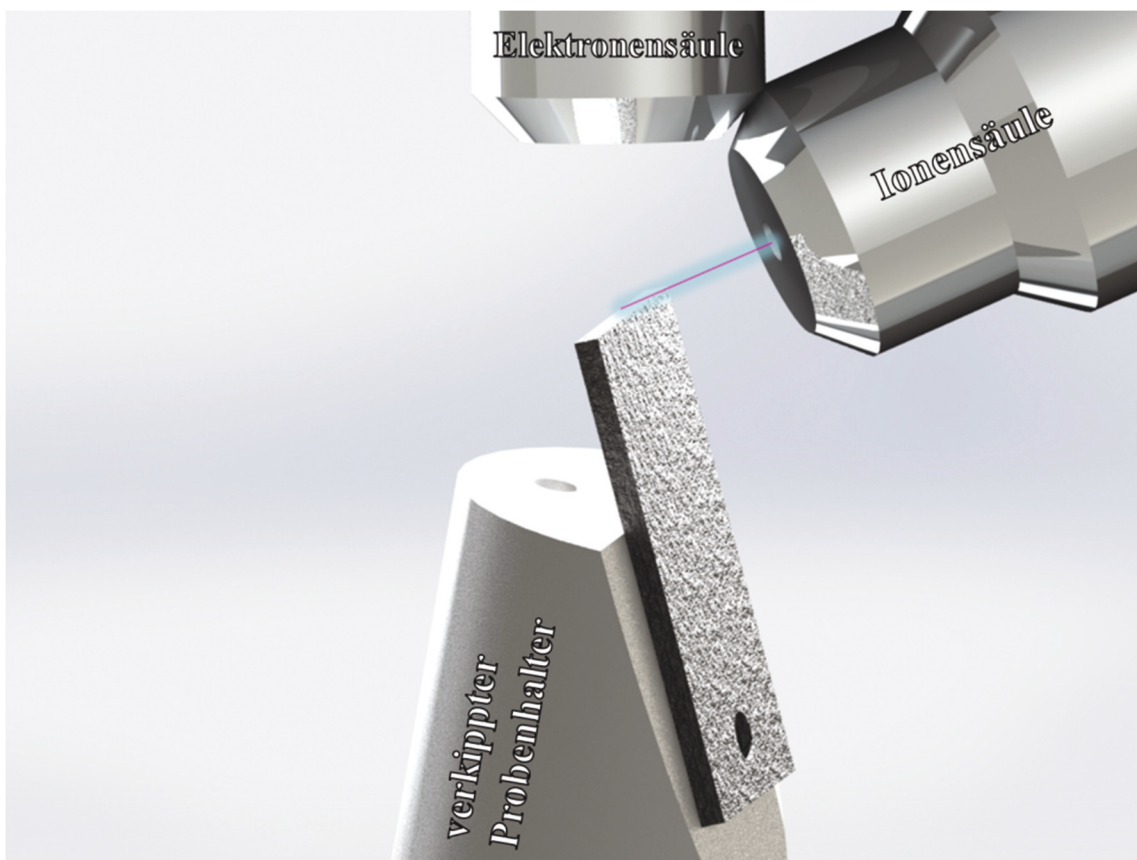
Abbildung 18: Schematische Darstellung der Querschliffpräparation mittels FIB-Technologie.
