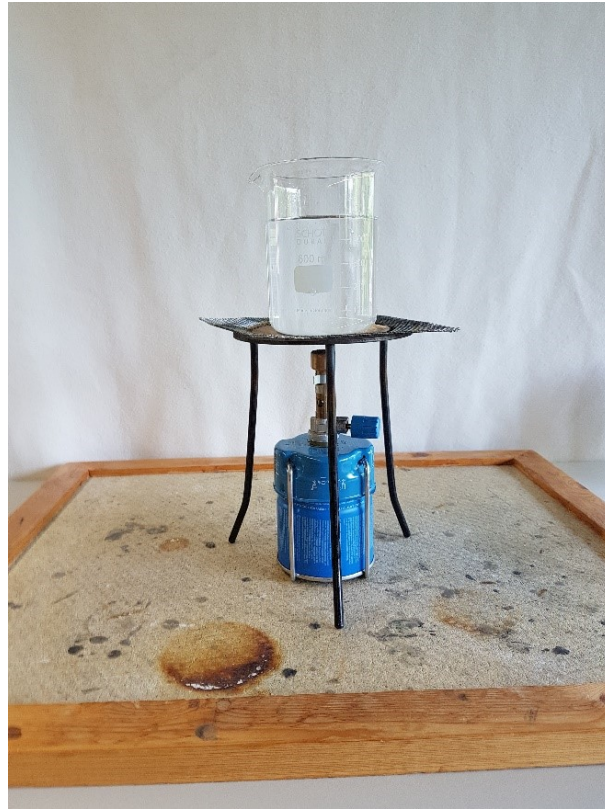
Abbildung 5.17. Aufbau des Versuches zu Konvektionsbewegung
