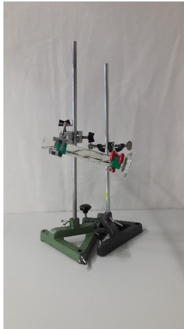
Abbildung 4.7. Aufbau des einfachen Höppler Viskosimeters
