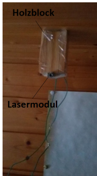
Abbildung 5.25. Lasermodul befestigt am Holzblock und an der Decke
