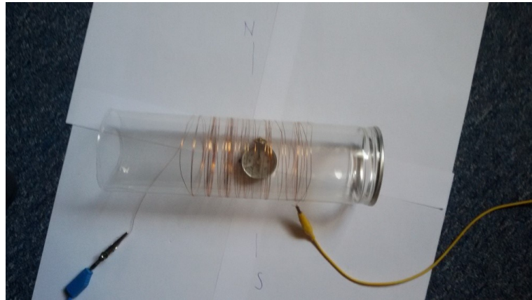
Abbildung 5.19. Ausrichtung der Kompassnadel
