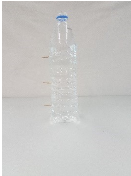
Abbildung 6.3. Versuchsaufbau (Schweredruck von Flüssigkeiten)
