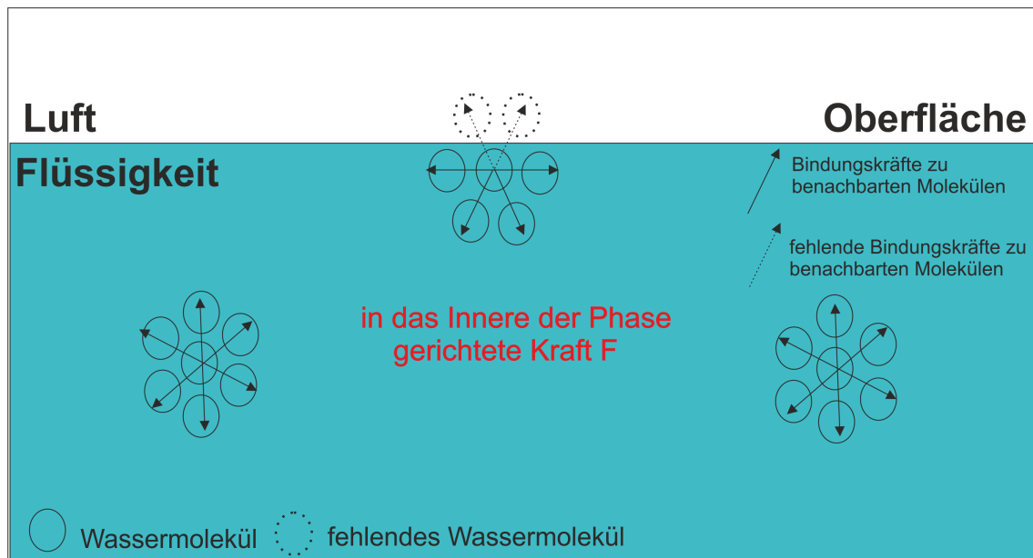
Abbildung 6.8. Entstehung der Oberflächenspannung (Skizze selbst angefertigt an Hand des Originals)(vgl. [SITsu])
