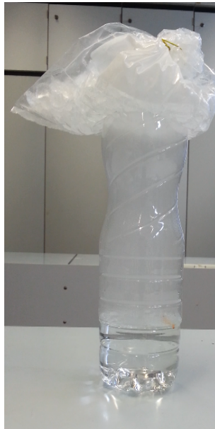
Abbildung 3.4. Verschlossene Flasche mit Ruß als Aerosole
