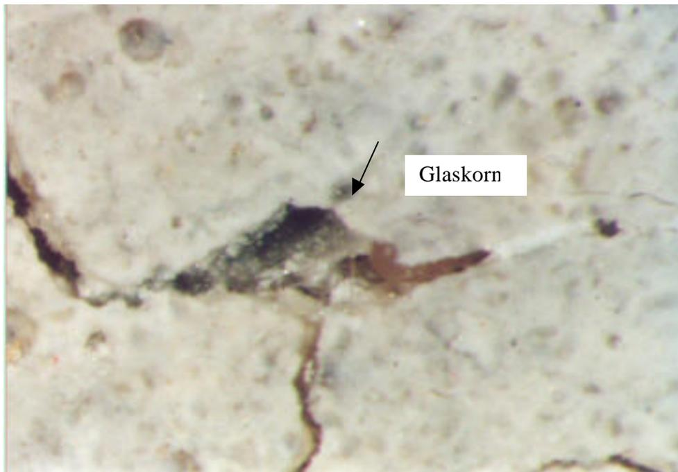
Abbildung 12: Mikroskopische Aufnahme der um ein Glaskorn angeordneten Risse in der Probe B45/H/K/G/L die 9 Monate in der Nebelkammer gelagert wurde.
