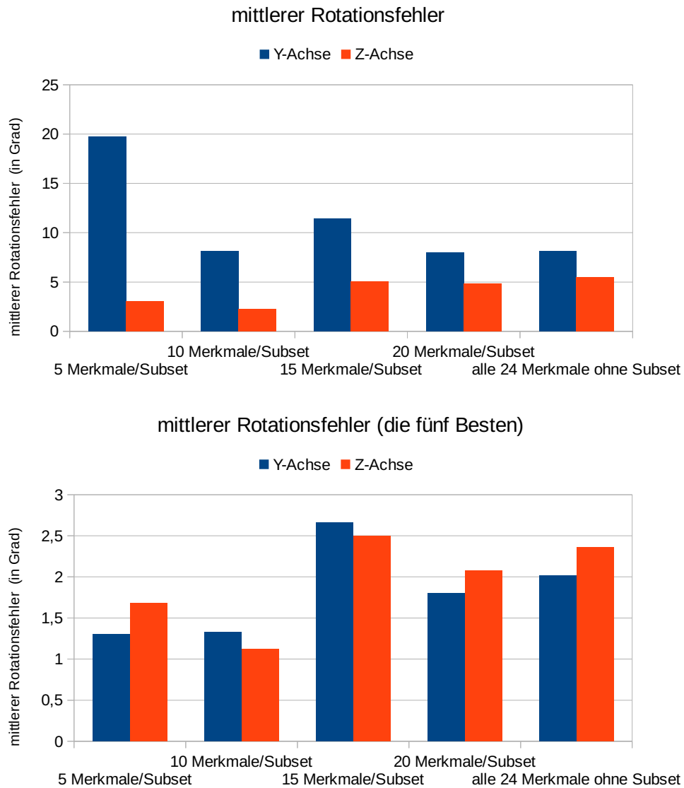
Abbildung 5.10: Mittlere Posenabweichung. Das obere Diagramm zeigt die mittlere Abweichung unter Verwendung von 5, 10, 15 oder allen 24 Merkmalen. Beim unteren Diagramm wurde der Mittelwert über die Beste der fünf Nächsten-Nachbarposen der Trainingsdaten gewählt. Die Grafik wurde vorab in [89] veröffentlicht.
