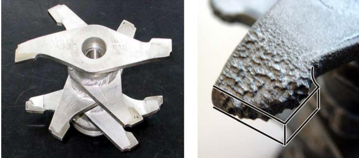
Abbildung 3-3 Links: Ein fabrikneuer Rotor. Die Rotorblätter werden um 60° versetzt an die Welle geschweißt (Bildquelle: Zoz GmbH). Rechts: Detailaufnahme einer verschlissenen Rotorspitze. Der Verschleiß wurde durch chemische Reaktionen zwischen Rotor und Pulver beschleunigt. Eingezeichnet ist die ursprüngliche Kontur der Rotorspitze (Bildquelle ohne Kontur: Labor für Oberflächentechnik, Universität Siegen).
