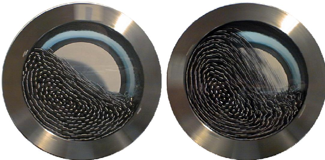
Abbildung 2-1 Die Abbildung zeigt die transparente Mahleinheit einer Labor-Trommelmühle. Die Trommel dreht um Uhrzeigersinn. Bei der Kaskadenwirkung (links) rollen die Kugeln übereinander ab. Bei der Kataraktwirkung (rechts) beginnen die Kugeln bereits zu fliegen und landen wieder im Kugelbett (Zoz et al., 2001a).
