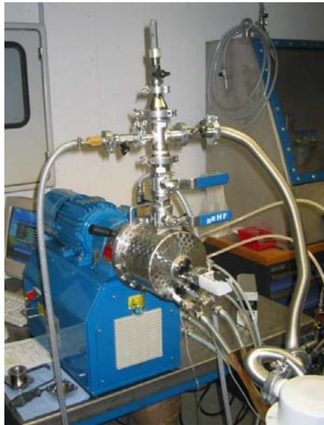
Abbildung 3-2 Labormaschine mit 2 Liter Mahleinheit. Der Turm auf der Mahleinheit dient zum Anschluss der Vakuumtechnik und der Pulverbehälter (oben). Befüllt wird die Mahleinheit im abgebildeten Zustand. Die Kugelhähne werden geöffnet und das Pulver fällt in die Mahleinheit (auch im evakuierten Zustand). Zum Entleeren wird die Mahleinheit mit dem Turn um  $180^\circ$  gedreht, so dass das Pulver wieder in den Behälter fällt.
