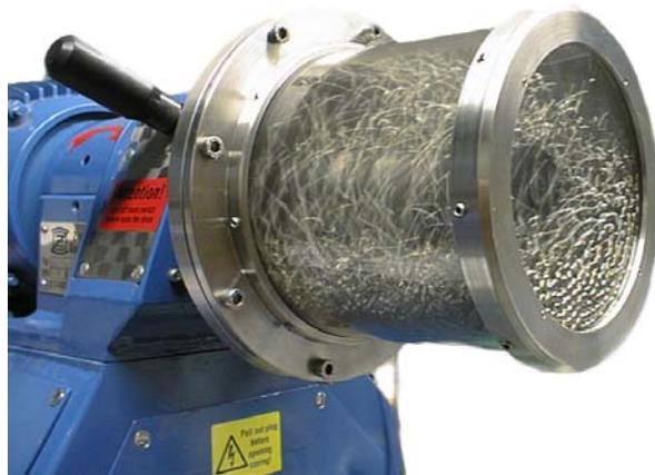
Abbildung 7-1: Foto der transparenten Mahleinheit bei 330 rpm. Durch die lange Belichtungszeit erscheinen die schnelleren Kugeln im oberen Bereich als Striche (Bildquelle: Zoz GmbH).
