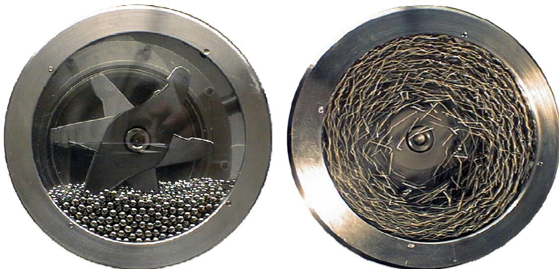
Abbildung 3-1 Die Mahltrömmel von Hochenergie-Kugelmühlen wird nur zu 20 – 40 % gefüllt (links ca. 20 %), damit die durch den hochtourig angetriebenen Rotor beschleunigten Kugeln Raum für den freien Flug haben. Der Mahleffekt beruht auf Schlagbeanspruchung des Mahlguts durch die kollidierenden Mahlkugeln (rechts). (ZOZ et al., 1999b)
