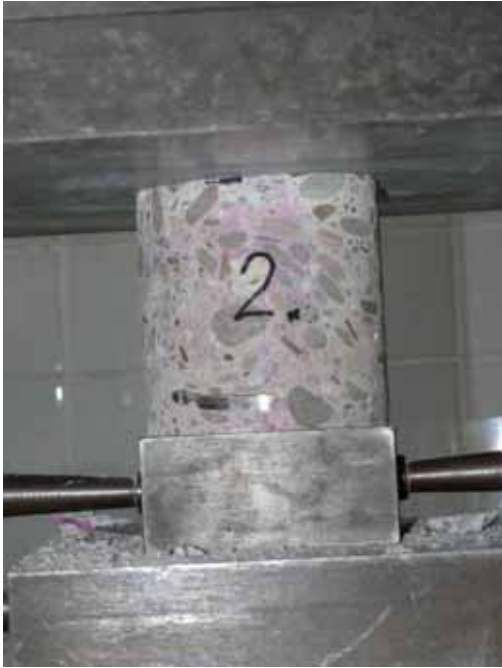
Abbildung 3-182 - Belastung der Bohrkerne... Abbildung 3-183 - ...bis zum Bruch
