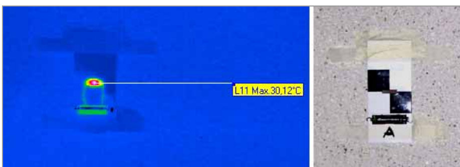
Abbildung 3-281 - Passpunkt in der Thermografie und im Digitalfoto (Q.:M. Wohlfahrt)
