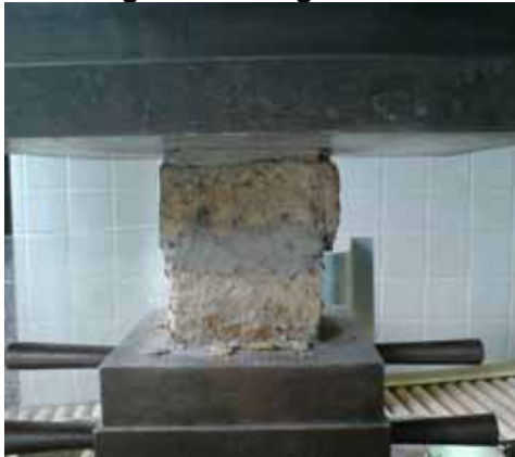
Abbildung 3-212 - Bruchbelastung der Proben
