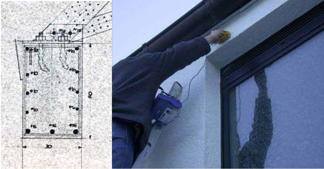
Abbildung 3-241 - Zeichnung zum Ringbalken (Q.: Archiv, Freie ev. Gemeinde, Waldbröl) Abbildung 3-242 -Überprüfung der Ringbalkenhöhe über die Ortung der Bewehrung mit dem Profometer
