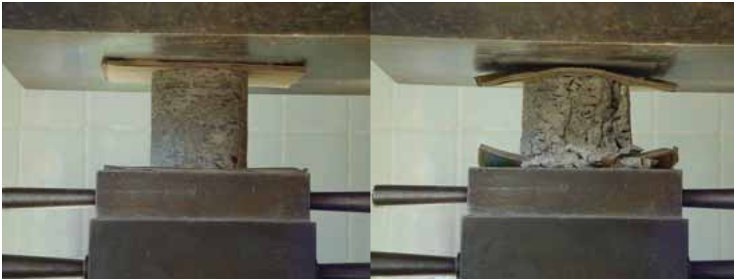
Abbildung 3-161 - Bohrkernprobe Abbildung 3-162 - Probe nach Versagen
