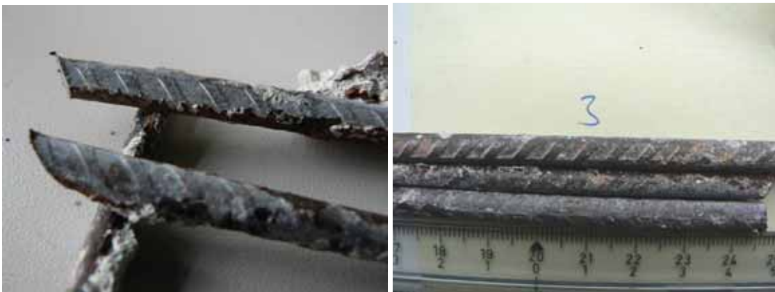
Abbildung 3-184 - Probe Mattenstahl Abbildung 3-185 - Probe Stabstahl
