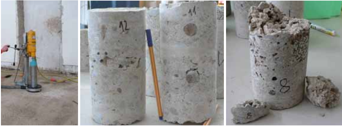
Abbildung 3-205 - Bohrkernentnahme in 11cm breiten Rippen Abbildung 3-206 - Bohrkern Nr.11 und 12 Abbildung 3-207 - Bohrkern Nr. 8 mit Auflösungserscheinungen
