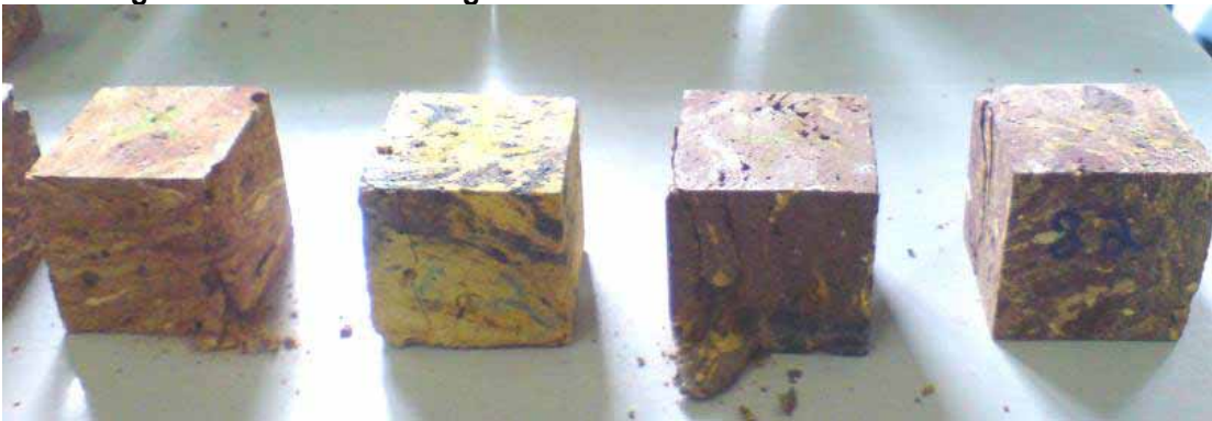
Abbildung 3-213 - Probenwürfel nach Belastung
