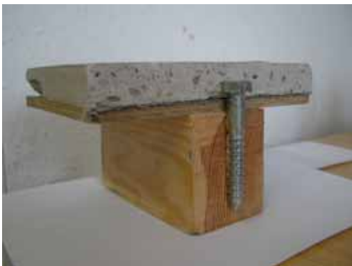
Abbildung 5-11 - Konstruktionsprinzip (Q.: http://www.uni-leipzig.de/statik/isd/pub/general/research/4/image_0.jpg , 17.01.2008)
