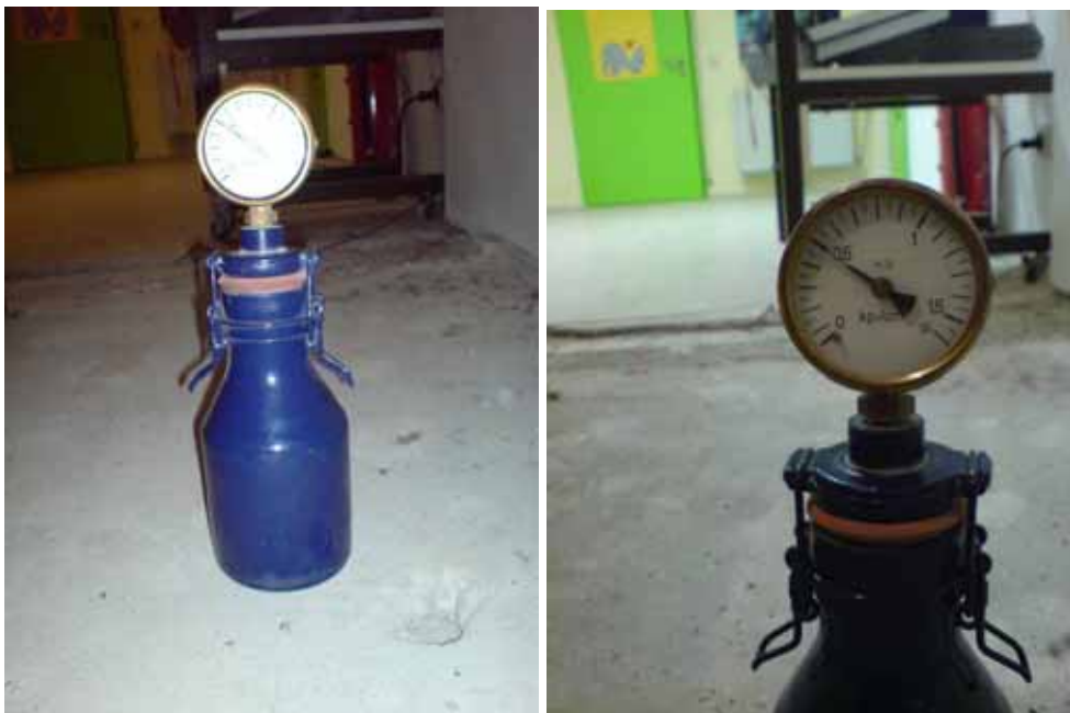
Abbildung 3-150 - Entnahmestelle und CM Messgerät
