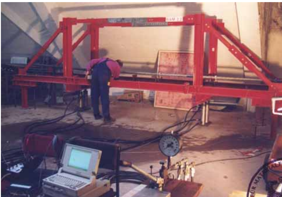
Abbildung 4-130 - Aufgebaute Prüfanlage vor Ort (Q.: BAM, Bericht AZ:2.2/24 062, Blatt18)
