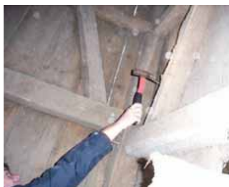
Abbildung 3-245 - Dachkonstruktion Scheune Abbildung 3-246 - Untersuchung der Holzkonstruktion... Abbildung 3-247 - ... mit dem Zimmermannshammer
