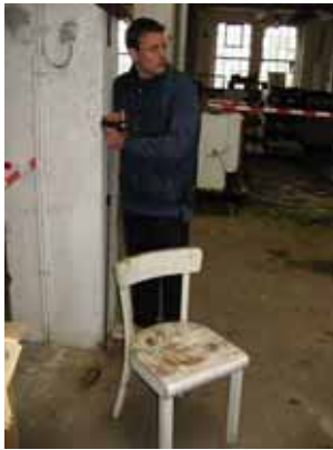
Abbildung 3-34 - Diagonalenmessung mit Laserdistanzmessgerät
