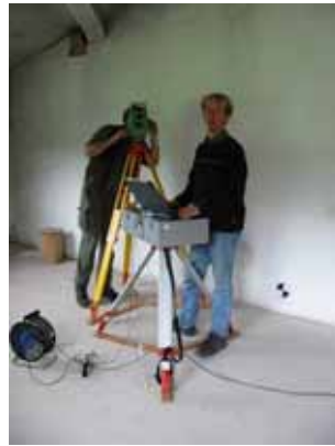
Abbildung 3-34 - Diagonalenmessung mit Laserdistanzmessgerät
