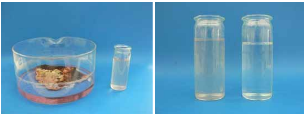
Abbildung 3-178 - Entnommene Probe mit verfärbtem Beton
