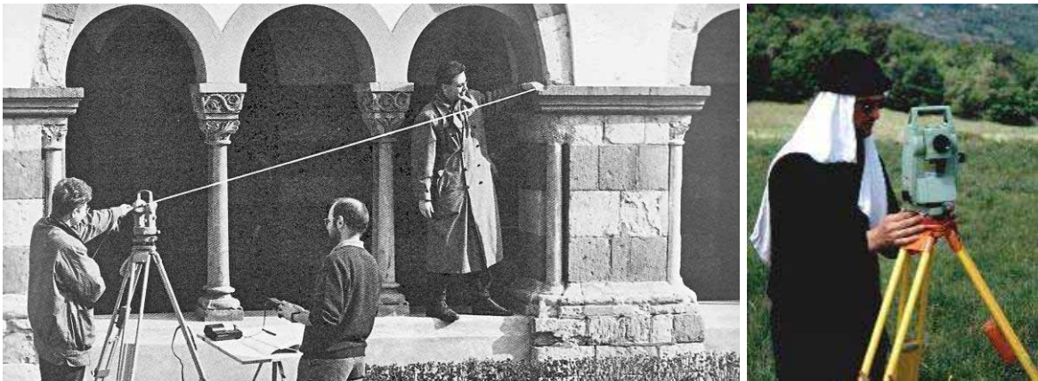
Abbildung 3-10 - Aufmaß mit Theodolit und Bandmaß (Q.: Knopp1992, S.53)
