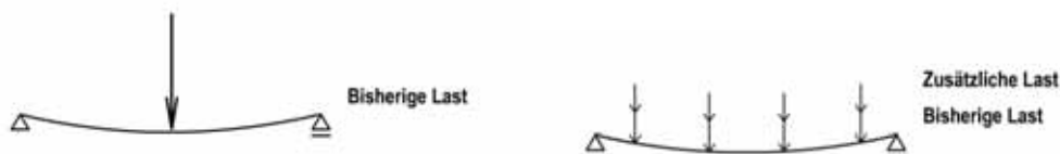
Abbildung 5-13 - Änderung der Lastverteilung
