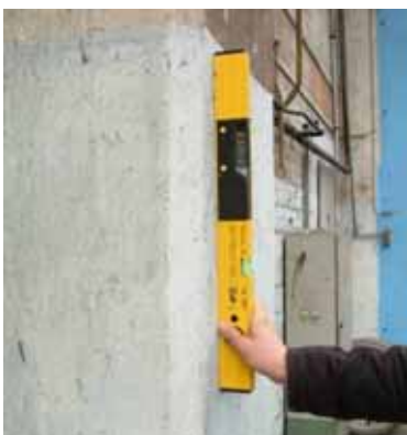
Abbildung 3-15 Digitale Wasserwaage, die Neigung wird im Display angegeben
