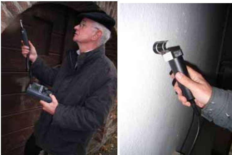
Abbildung 3-152 - Messgerät mit Kugelkopf Abbildung 3-153 - Dielektrizitätsmessung
