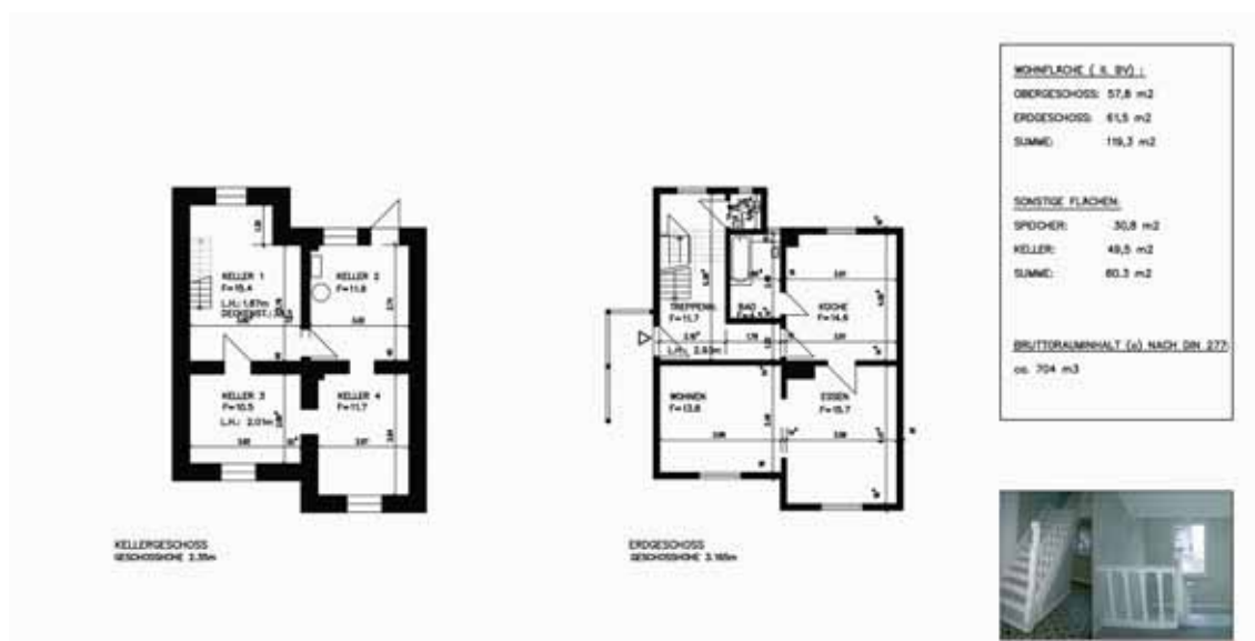
Abbildung 3-87 - Grundrisse mit Flächenberechnung
