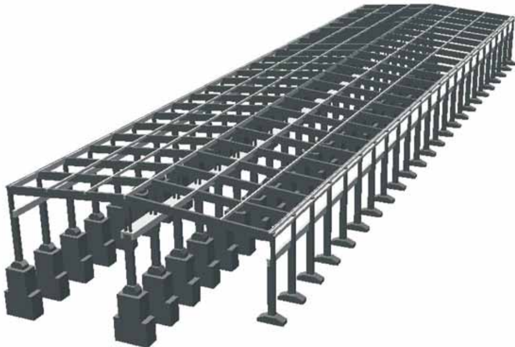
Abbildung 4-71 - Darstellung der tragenden Bauteile für Vertikallasten
