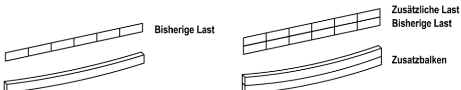
Abbildung 5-3 Obere oder untere Verstärkung
