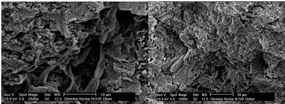
Abbildung 4-88 Betonoberfläche im oberen Wandbereich 2500-fach vergrößert (Q.: Istitut f. Bau- und Werkstoffchemie, Universität Siegen)
