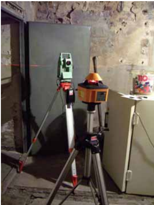
Abbildung 3-57 - Mit Rotationslaser markierte Schnittebene für Kellergeschossgrundriss... Abbildung 3-58 - ...und Gewölbeschnitt (Laser oben Mitte)
