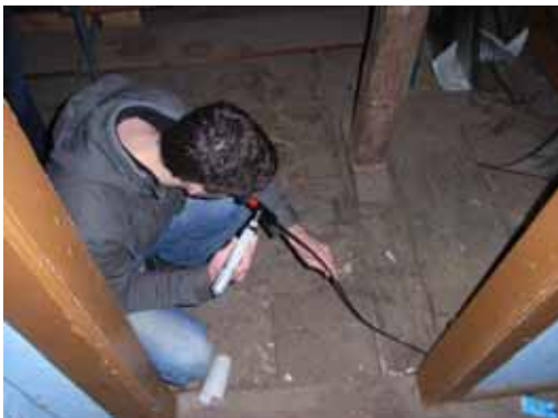
Abbildung 3-146 - Untersuchung eines Hohlraumes in einer Balkendecke mit einem flexiblen Endoskop
