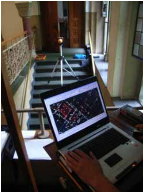
Abbildung 3-60 - Datenübertragung zum Laptop, der Rotationslaser im Hintergrund markiert die Schnittebene
