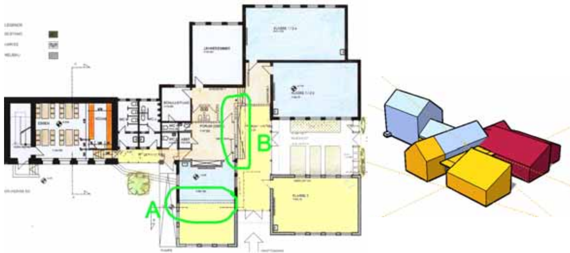
Abbildung 5-126 - Erdgeschossgrundriss, Ergänzungsflächen: gelb Abbildung 5-127 - Isometrie, ergänztes Volumen: gelb
