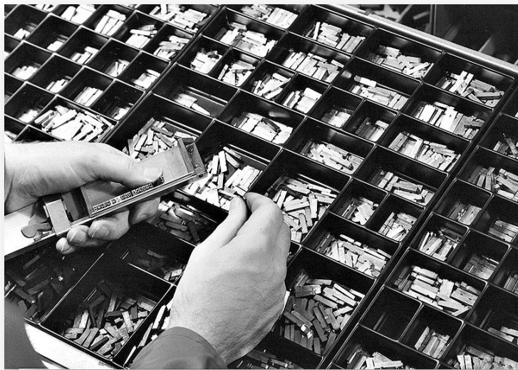
ABBILDUNG I-2: DER SETZKASTEN WAR EIN WICHTIGES HANDWERKSZEUG DES SETZERS. (ARCHIVFOTO: SIEGENER ZEITUNG)
