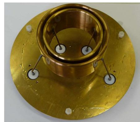
**Abb. 3.10:** Aufbau zur Messung des Verlustfaktors und der Kapazität von Isolierflüssigkeiten nach DIN/EN 60156 (VDE 0380 Teil 2), rechts die Messelektrodenanordnung
