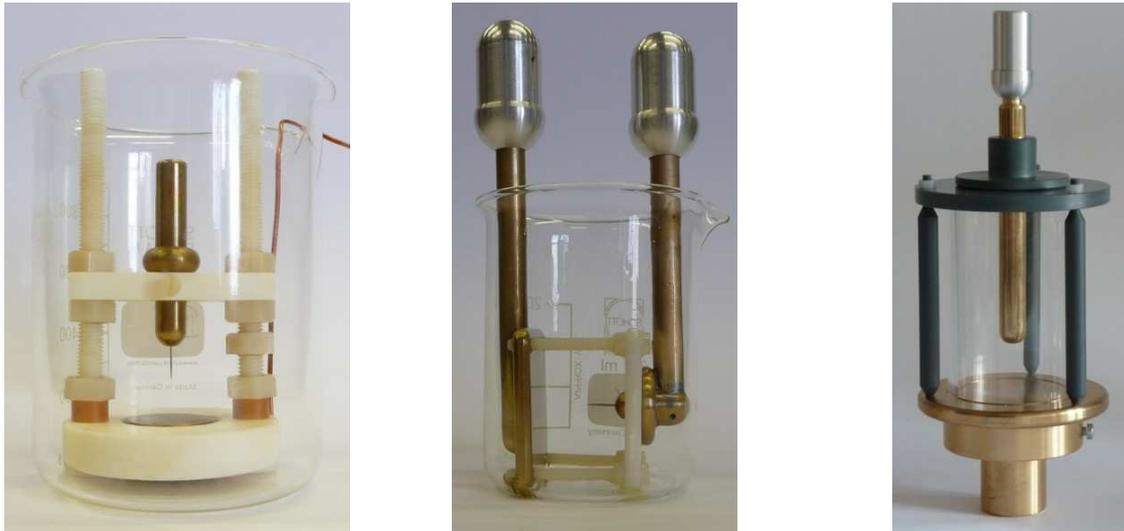
Abb. 3.9: Messzellen MZ I, II und III (von links)
