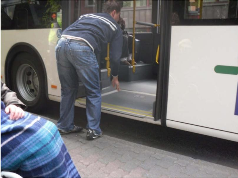
manuell zu betätigende Rampe, keine Erhöhung an Bushaltestelle
