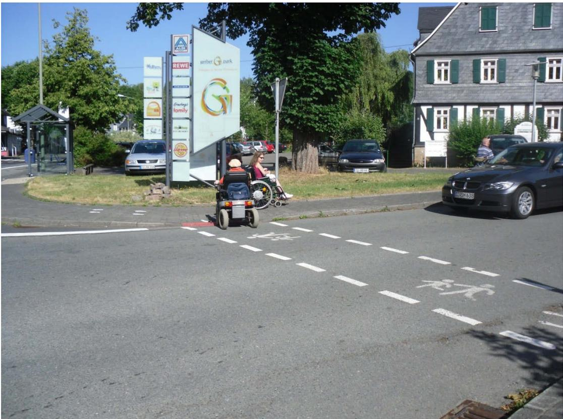
Positiv: Übergang abgeflacht und farblich, durch einen roten Streifen, abgesetzt (siehe nächstes Bild). Überquerung deutlich markiert
