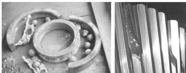
Abbildung 1.3: Beschädigtes Lager eines Windnachführungssystems (links); Verzahnungsschaden des Sonnenrades eines Planetengetriebes (rechts)
