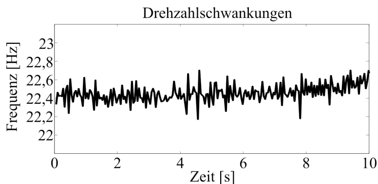
Abbildung 5.59: Drehfrequenz der schnellen Welle im betrachteten Signal
