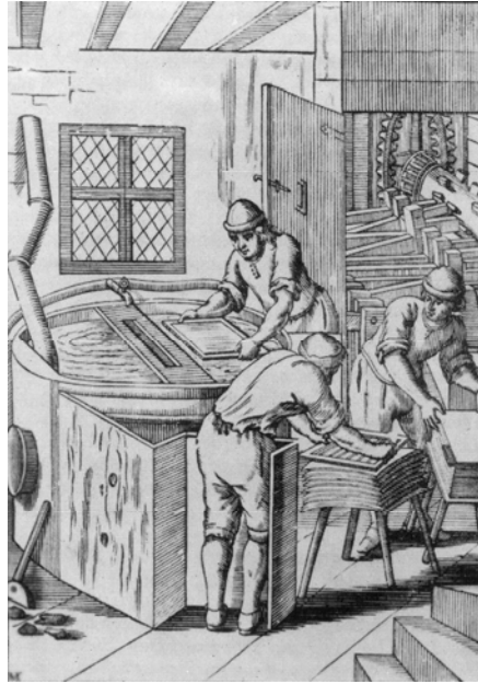
Abb. 2: Schöpfer, Gautscher und Leger bei der Arbeit; im Hintergrund das Lumpenstampfwerk. Nach einem Holzschnitt von 1689 (Weiss/Weiss 1962: 28).
