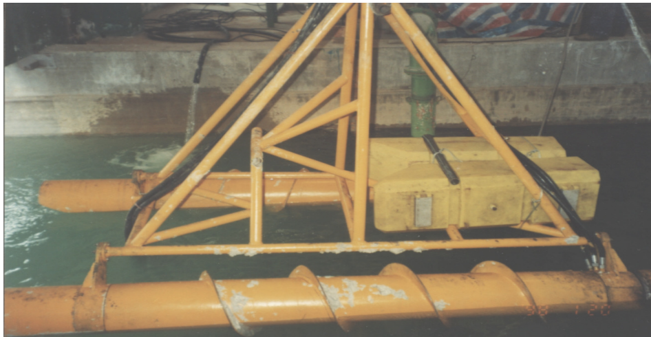
Bild 2.2: Französisches Fahrwerk mit archimedischen Spiralen
