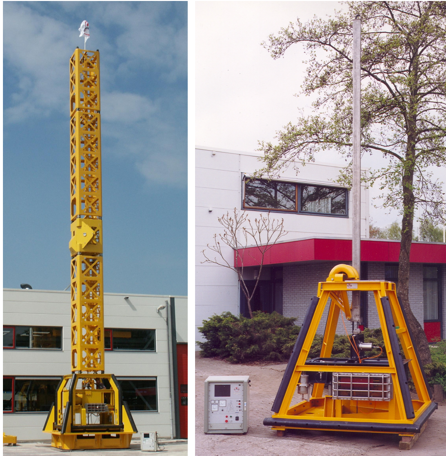
Bild 2.8: Messsysteme mit Kegeldrucksonde und Flügelschersonde für den Einsatz bis in 2000 Meter Wassertiefe
