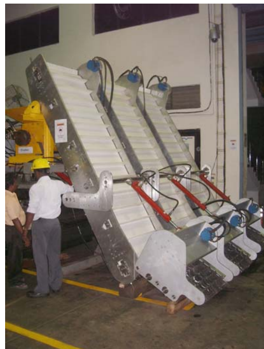
Bild A 6.4: Mechanischer Kollektor des NIOT (mit freundl. Genehmigung der Deep Sea Technology and Ocean Mining Group, NIOT, Ministry of Earth Sciences, Govt. of India)
