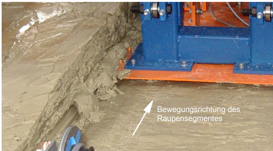
Bild 4.26: Seitliches Aufwerfen des Bodens am Raupensegment
