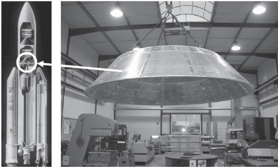
Abbildung 3.25: Prototyp eines konischen Spants für die Ariane 5 Trägerrakete mit einem Durchmesser von 4m (aus [99])
