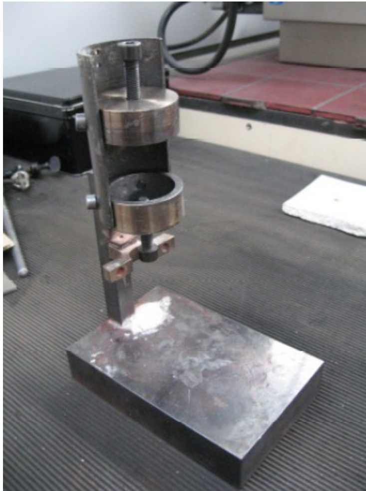
Abbildung 4.5: Vorrichtung zum Eingießen von Schwammproben
