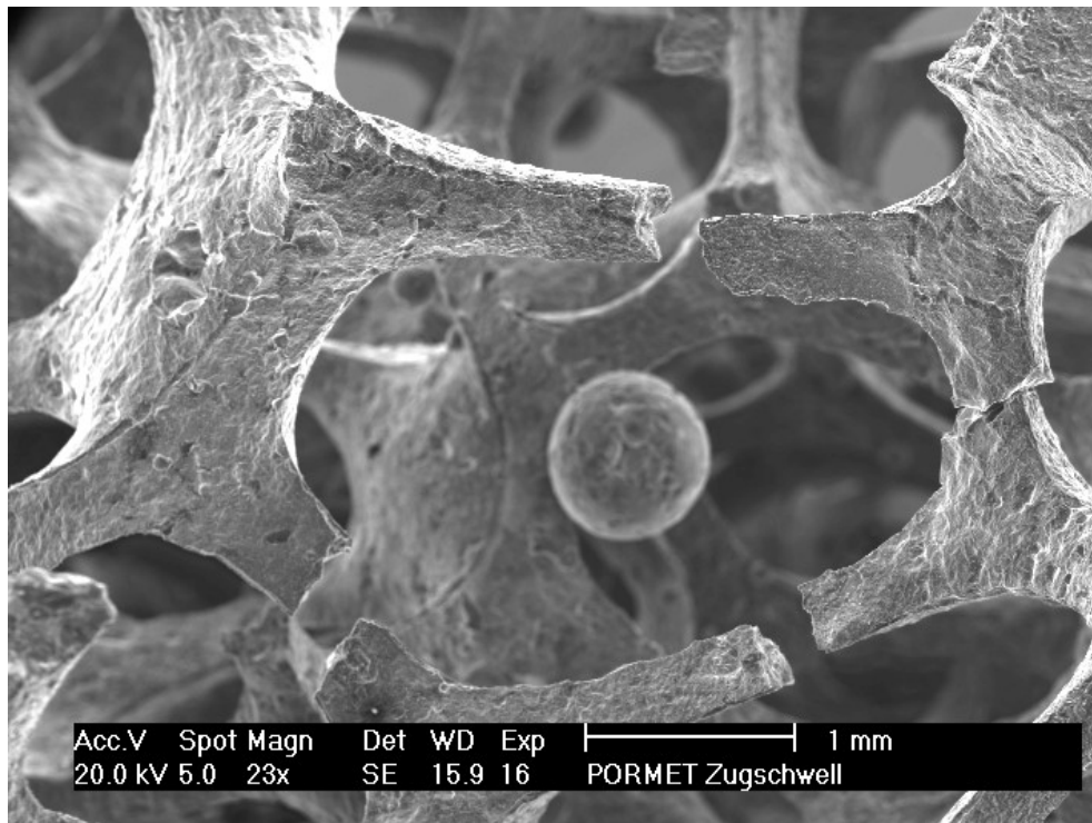
Abbildung 5.54: Ermüdungsbrüche der Zellstege eines PORMET-Schwamms unter Zugschwellbeanspruchung
