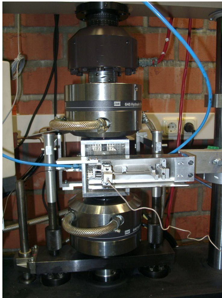
Abbildung 4.4: Einbauraum des Prüfsystems MTS 810 mit digitaler Regelelektronik MTS TestStar IIs
