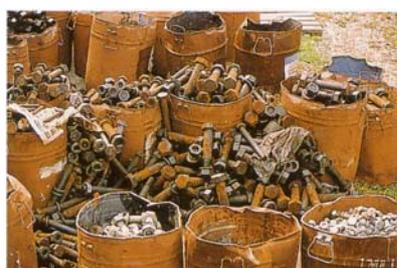
**Abb. 54: Eisenteile verrosten an der Luft**
