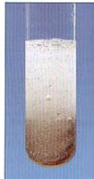
**Abb. 47: Reaktion von Zink mit Salzsäure unter Bildung von Wasserstoff**
