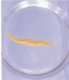
**Abb. 46: Bildung von Bleiiodid im „Petrischalen-Versuch“**
