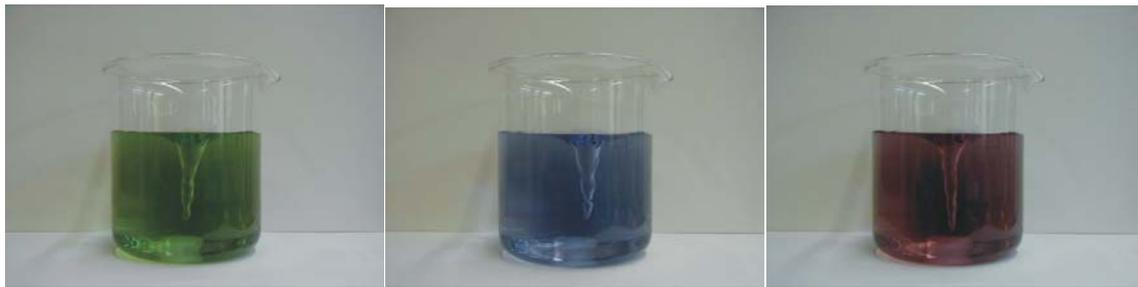
**Abb. 21, 22 und 23:** Belousov-Zhabotinsky-Reaktion mit dem periodischen Wechsel der Farben grün, blau und rot (System aus Kaliumbromat, Malonsäure, Kaliumbromid, Cer(IV)-ammoniumnitrat, Schwefelsäure und Ferroin). Die Lösung wird kontinuierlich durchmischt. Aus E. K. Kretzer (2002), 42.
