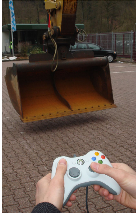
Abbildung 3.8: Bedienung des Versuchsbaggers über die Daumenjoysticks eines Gamepads mit USB-Schnittstelle
