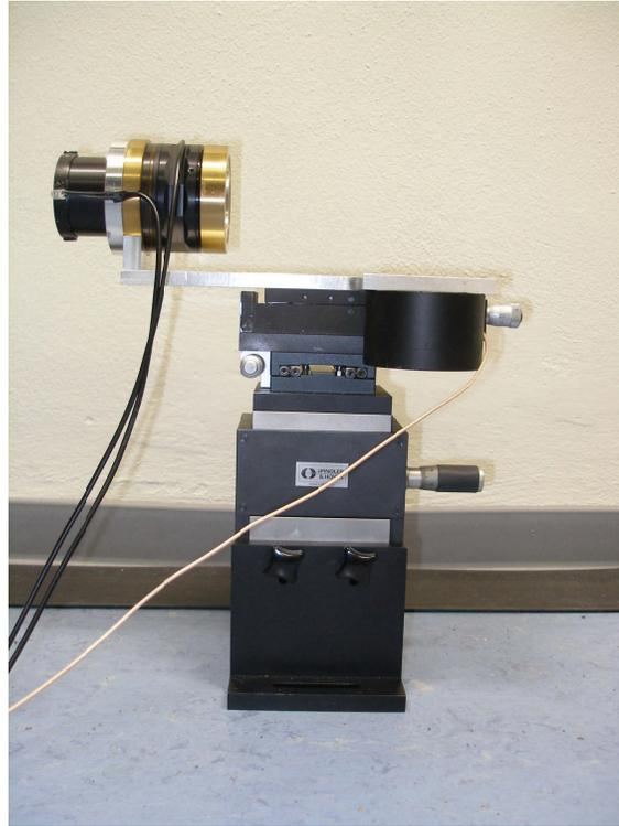
**Abbildung 4.20:** Abbildung des Objektivaufbaus zur Abbildung der Ionen.
