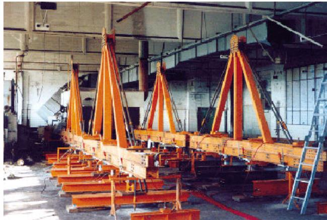
**Abb. 2.1:** Belastungsrahmen zur Prüfung einer Geschossdecke [31]
