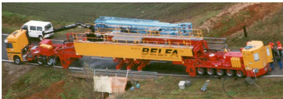
**Abb. 2.2:** Luftansicht des Belastungsfahrzeuges für Straßenbrücken [8]
