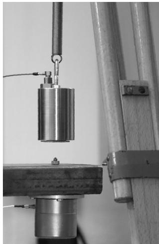
**Abb. 7.3:** Impulserzeugung im Labor
