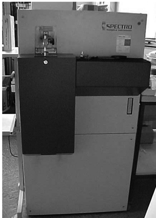
Bild 3.6: Automatisches Funkenspektrometer (SPECTROLAB, Firma SPECTRO Analytical Instruments, Kleve)
