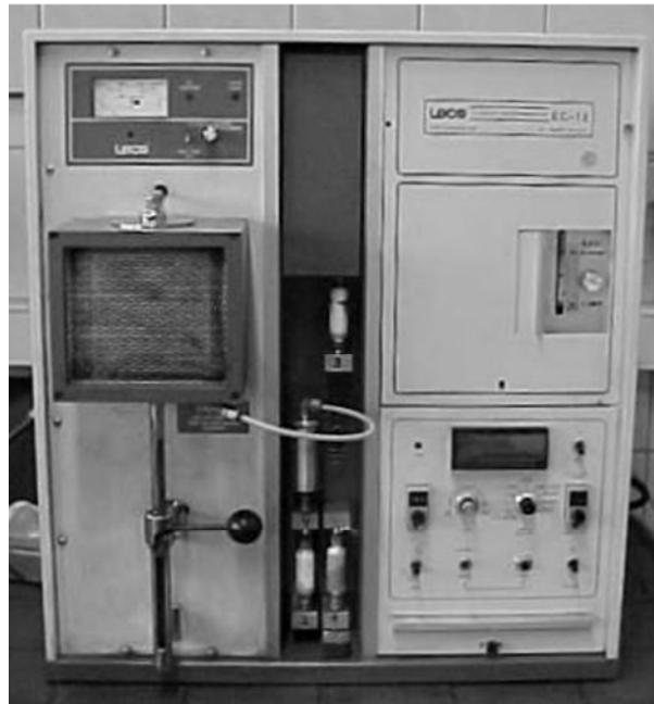
Bild 3.5: Messgerät für das Kohlenstoffausbrandverfahren (LECO EC-12, Firma LECO, Mönchengladbach).
