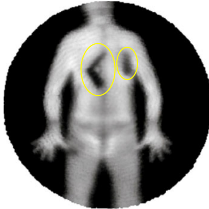
Abb. 2.13: Bild eines Menschen mit einer unter der Kleidung versteckten Schreckschusspistole und einem Päckchen mit Weinsäure als Imitation eines Sprengstoffs, aufgenommen bei 350 GHz mit einer Bildwiederholrate von 1 Hz [83].
