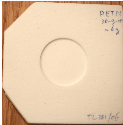
Abb. 4.2: Beispielhaft für alle in Rohacell eingekapselten Proben wird hier die PETN Probe gezeigt. Die Kantenlänge der Rohacell-Ummantelung ist ca. 120 mm. Die runde Vertiefung in der Mitte mit einem Durchmesser von 50,4 mm zeigt die Position der Probe im Rohacell an.
