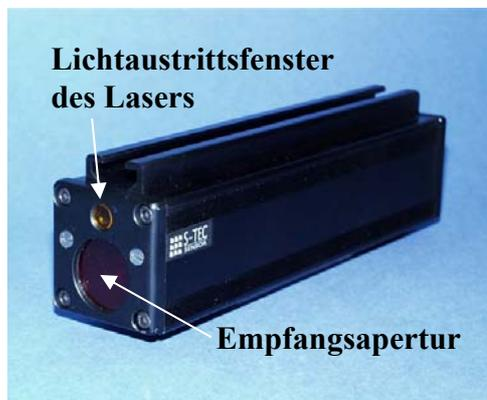
Abb. 2.38: PMD-basiertes 1D-Entfernungsmessgerät
