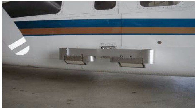
Abbildung 5-3: Am Flugzeug montierte ATI SAR Antennen
