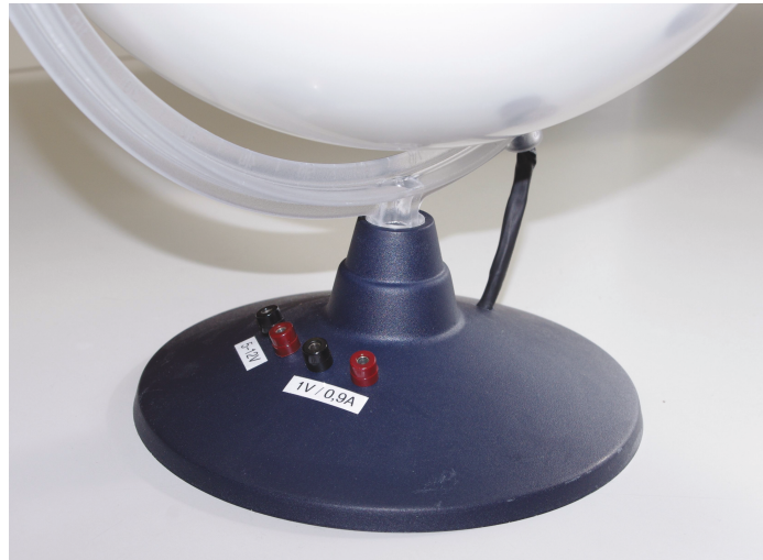
Abbildung 6.24: Kabelführung zum Sockel – Nahansicht.
