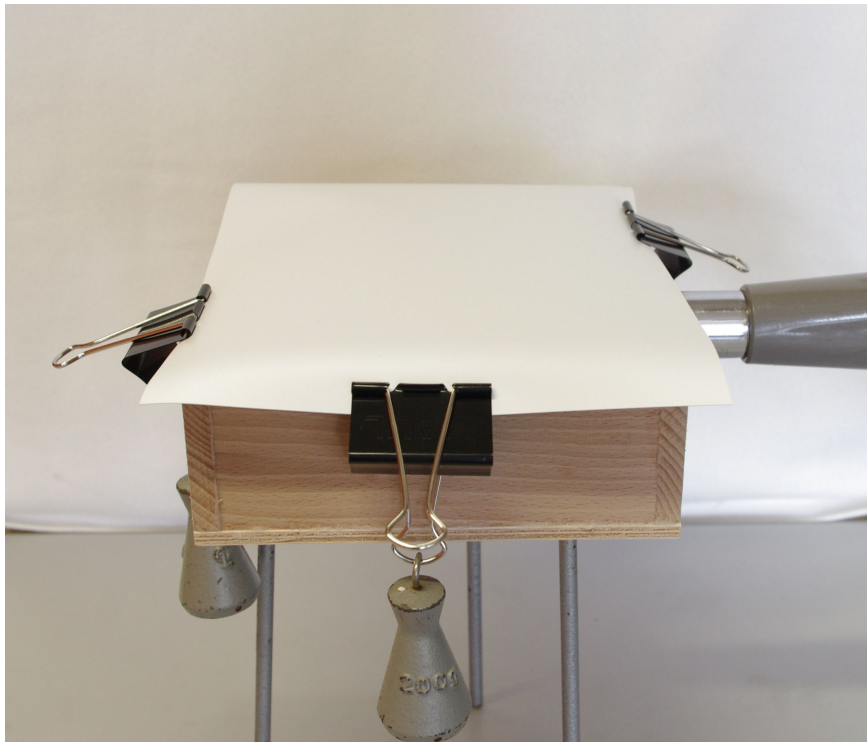
Abbildung 6.38: Tiefziehmaschine mit aufgelegter Folie und angehängten Gewichten.
