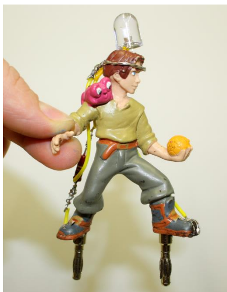
Abb. 7.36: Spielfigur ausgestattet mit einer Leuchtdiode und einem Vorwiderstand für die Anzeige der Schrittspannung.
