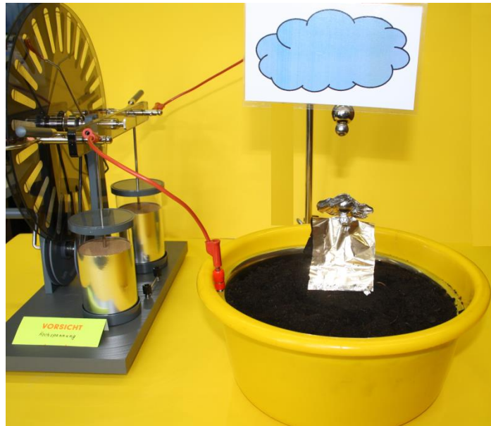
Abb. 7.38: Aufbau des Modell-Versuches zur Veranschaulichung der Gefahren und Vorsichtsmaßnahmen bei einem Gewitter.
