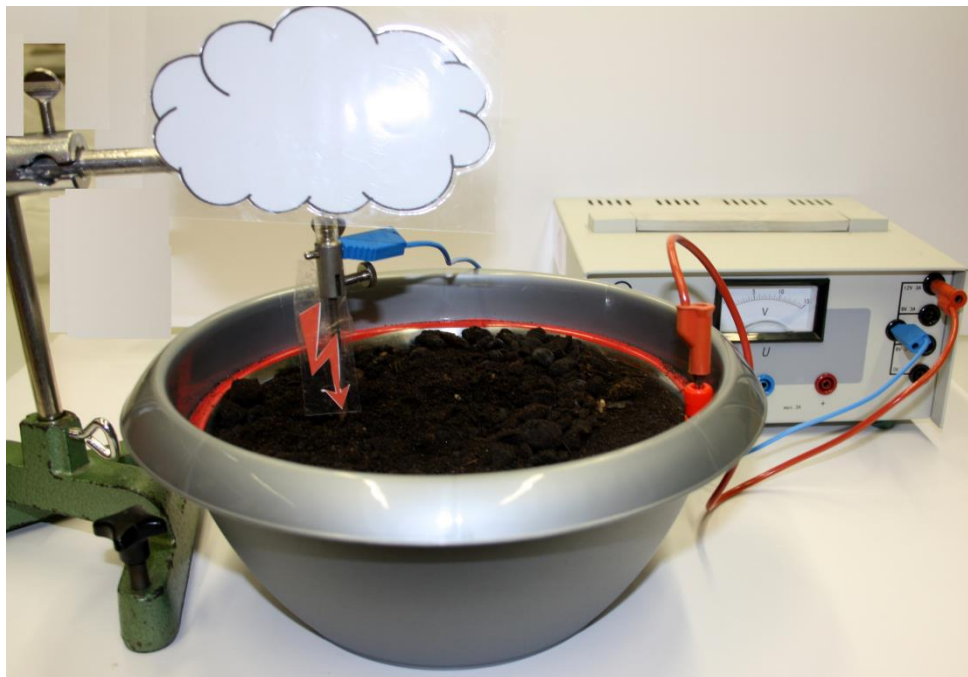
Abb. 7.37: Aufbau des Modell-Versuches zur Veranschaulichung der Schrittspannung.
