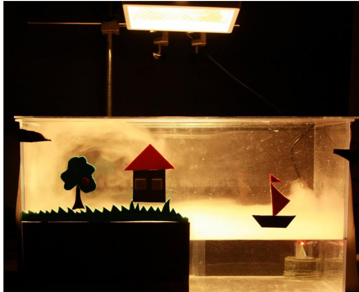
Abb. 7.26: Das Ergebnis des Schülerversuches zur Windentstehung. Die Luftströmungen werden mithilfe des Wasserdampfes verdeutlicht.
