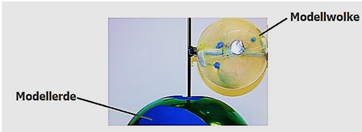
Abb. 7.35: Aufbau des Modells zur Entstehung der Gewitterelektrizität.
