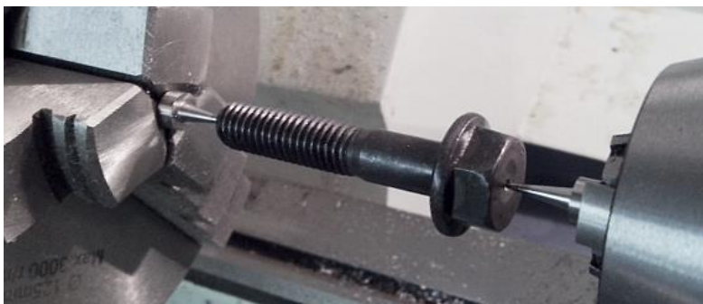
Abb. 36: Verdichtung der Messpunkte am Grund der Zentrierbohrungen an der Drehbank
