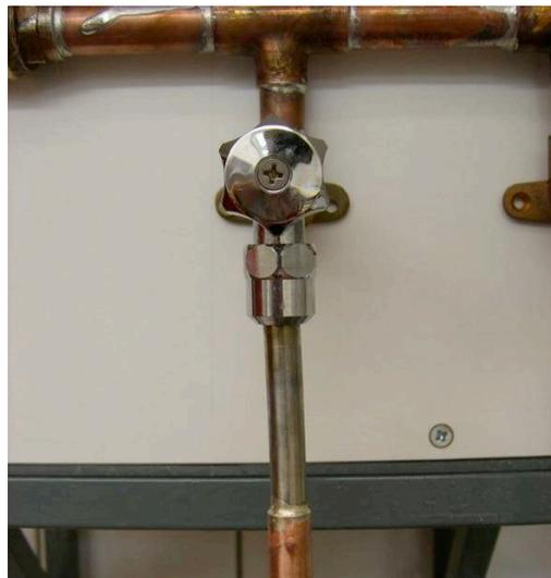
Dieses Rohrsystem wurde so konfiguriert, dass am jeweiligen Ende eines jeden Testrohres das Wasser kontinuierlich heraustropfte, jedoch niemals stagnierte.
