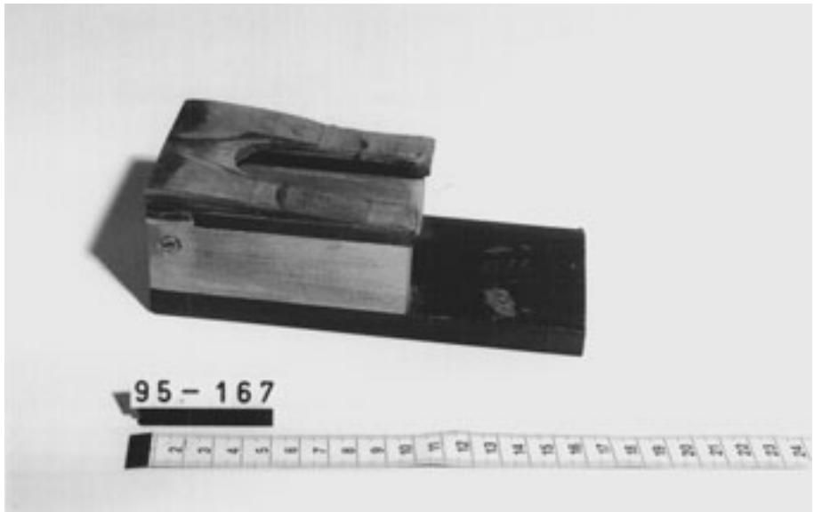
Abb. 124: Verleimform, Typ 4 (Grundtyp)
