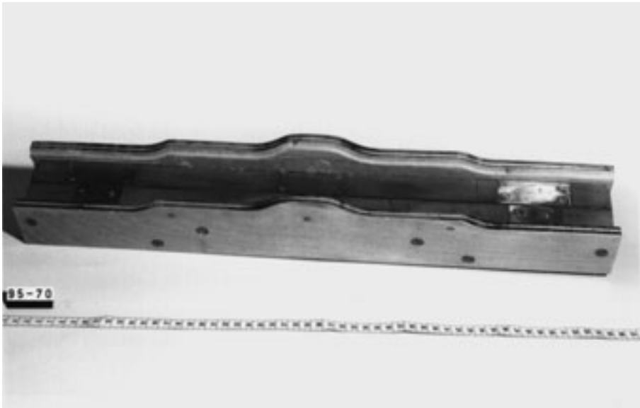
Abb. 58: Besenfräsform, Typ 1 (Grundtyp)
