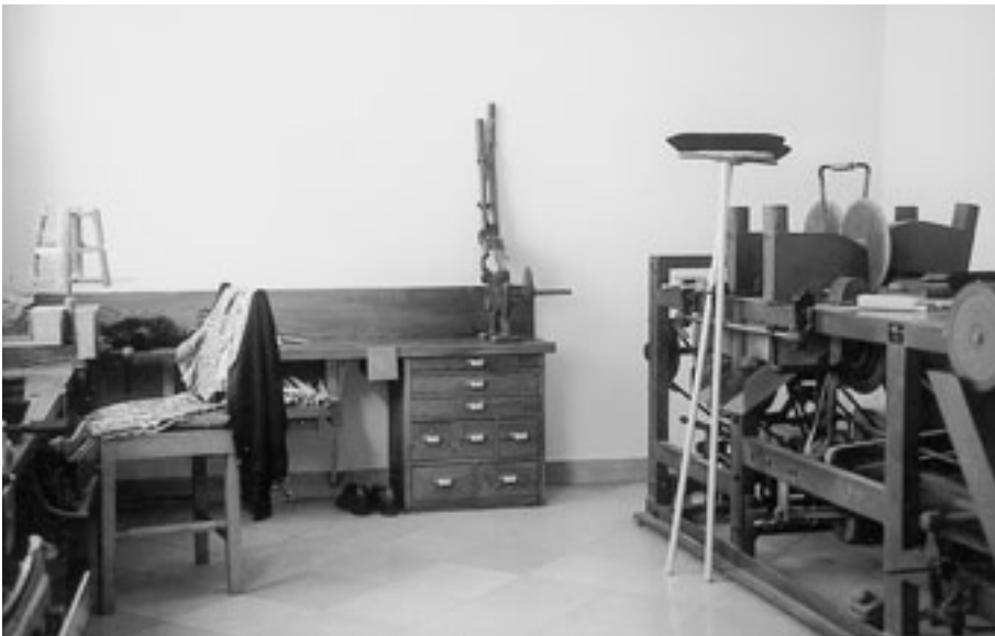
Abb. 8: Der Werkraum. Rechts ein Teil der Mischmaschine. Vor Kopf die Einziehbank mit Schränkchen und Stockschere. Links der „Deckelpreßapparat“ mit Drahtaspel, Frühjahr 1994
