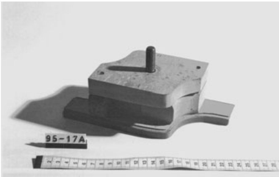
Abb. 71: Doppelfräsform mit Deckel (für Bürstenhölzer ohne Stiel), Typ 1 (Variante b)
