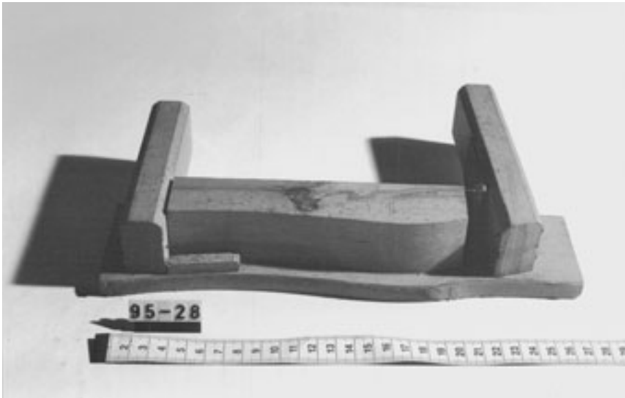
Abb. 85: Einzelfräsform mit seitlich angebrachten Haltegriffen, Typ 1 (Variante a)
