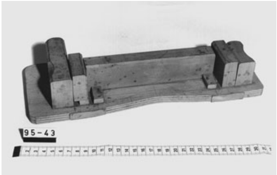
Abb. 87: Einzelfräsform mit seitlich angebrachten Haltegriffen, Typ 2
