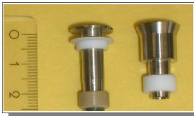
← links: Eigenkonstruktion für Schraubkappen-Vials
