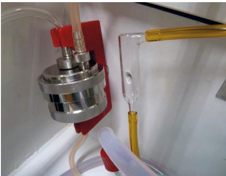
Abb. 5.1.1.9.: Windkesselaufsatz. Das Luftpolster kann in der Höhe variiert oder ganz ausgeklemmt werden, um z.B. eine Pulsatilität von Fluss und Druck zu erreichen. Links inline Filter mit Entlüftung-stutzen (Fa. Sartorius, Göttingen, BRD).
