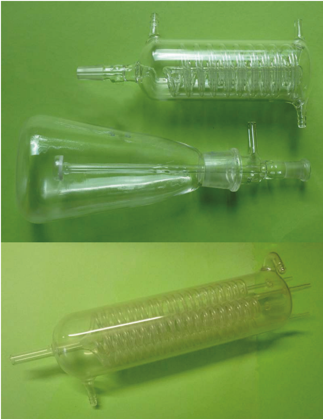
Abb.15.1.0.: Ensemble zur Gasbefeuchtung und Anwärmung. Oben ist eine Fritte, die in einen mit destilliertem Wasser gefüllten Erlenmeyerkolben mit Schliff eingepasst wird und das Gas über die darüber abgebildete Gasschlange vorgewärmt erhält. Der Erlenmeierkolben wird in ein Wasserbad eingetaucht (s.a. Abb. 5.1.1.0.). Über die Glasschlangen des unteren Bildes wird nachgewärmt mit dem Vorteil, dass man kein Kondenswasser ins Perfusionsmedium verschleppt. Die Anordnung der 4-fach Schlange war der Phase geschuldet, als im single pass Modus mit bis zu vier verschiedenen Substraten der Einfluss auf den Natriumtransport untersucht worden war (bis zu 4 Woulffsche Flaschen mit jeweils 2 Litern Perfusatvariante hintereinandergeschaltet (246, 247)).
