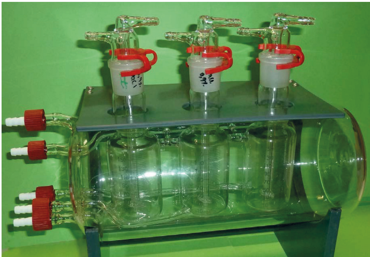
Abb. 5.4.3: Bild einer temperierbaren 3-fach Kammer. Damit können 3 verschiedene Lösungsvarianten sequentiell als Rezirkulationsperfusion realisiert werden. Zwischen den Wecheln wird im single pass Modus Medium verworfen um eine Kontamination der Nachfolgelösung zu vermeiden. Die beiden Anschlüsse oben sind Wasserbadanschlüsse. Die drei Anschlüsse unten sind den drei Kammern zugeordnet. S.a. technischer Anhang.
