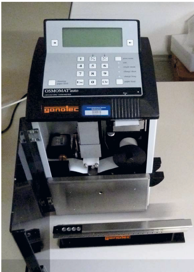
Abb. 9.1.2.: Serienmeßgerät mit Gefrierpunkt-Erniedrigung.
