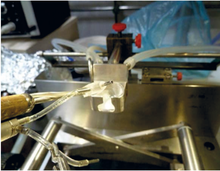
Abb. 8.1.1.9.: Frontalbild der doppel-läufigen Kanüle. Im Bild ist die Innen-Kanüle der doppel-läufigen Aortenkanüle gut zu sehen, weiter unten im Bild der abgeklemmte Bypass-Schlauch für die arterielle pO_2 -Messung, im Hintergrund die Nierenschale mit Wasserbadanschlüssen, links der Absaugschlauch an der Nierenschale. Rechts von der Nierenschale ist die rechteckige Öffnung, in die der Arm des Effluattrichters eingesetzt und fixiert wird.
