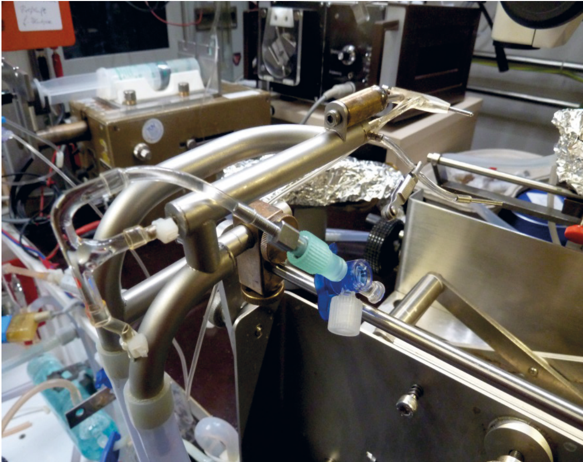
Abb. 8.1.2.5.: Die „ Perfusions-Pistole “ ist bis zu der aufgesetzten Frontmagnetschale, in die der Kugelkopf der Aortenkanüle passt, mit Wasserbad temperiert. Links der Zulaufarm, unten über einen Schlauch angeschlossen, rechts der die Kanüle tragende Arm, der ein zuführendes Edelstahlröhrchen enthält das außen an ein wie ein F konfiguriertes Glasrohr angeschlossen ist, das als ein letzter Blasenfänger dient und potentiell als Abnahmestelle für arterielles Perfusat*. Der Ablaufschlauch enthält innen den dünneren Perfusatschlauch aus Tygon. In den Intervallzeiten werden Perfusionskanüle und Innenschlauch nach Freispülen mit 3% Formalinlösung gefüllt bis zum Folgeexperiment.
