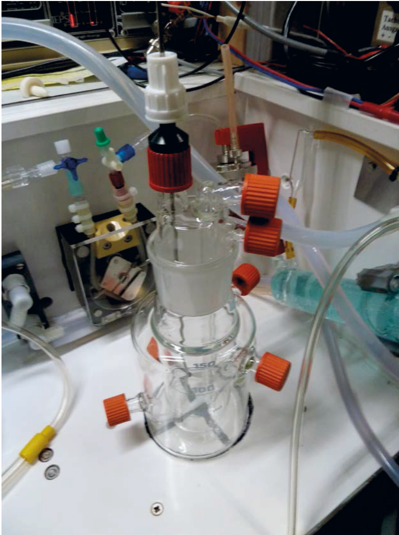
Abb. 5.3.2.: Doppelwand-Perfusatbehälter mit Rührmagnet , mit verstellbarem Füllstandsmeßstab und Doppelglasrohr für das Rezirkulat (Detail rechts), im zentralen Rohr wird das Aliquot für die Blutgasmessung zurückgeführt über ein eingestecktes Edeltahlröhrchen, das zudem Kontakt herstellt zum Perfusat für die elektronische Füllstandsregelung, die für die Perfusionsvariante Rezirkulation mit Dialyse genutzt wird (s.a. Abb. 5.2.3, dort ist das Röhrchen eingesteckt).
