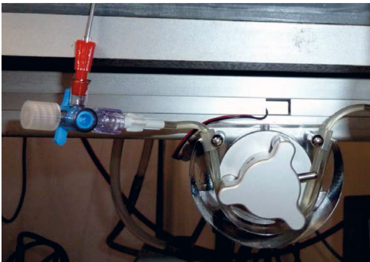
Abb. 5.1.2.3.: Kleine Rollerpumpe, die das Messliquot zur O 2 -Elektrode transportiert (ca. 3-4ml/min).
