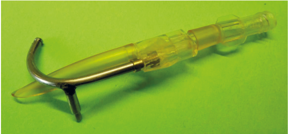
Abb. 4.4.0.: Venenkanüle zum Einschwenken in die Vena cava. Die Venenkanüle kann um den T-Abgang gedreht und in die Vena cava von cranial eingeschwenkt werden bei offenem distalen Ende der Vena cava. Nach Einbinden der Kanüle wird das distale Ende der Vena cava verschlossen. Das Effluat fließt in den Trichter unterhalb der Nierenschale, rechts ist ein Lueranschluß für eine venöse Probenentnahme. Außendurchmesser der Kanüle 3,2mm. Der dünnere Teil des T-Abgangs nimmt den Tygonschlauch auf zur pO_2 Druckmessung.
