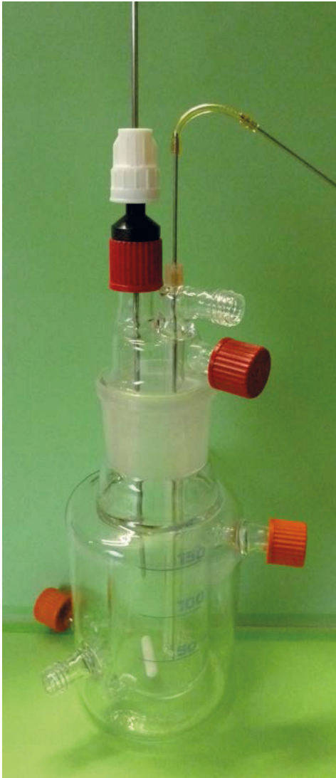
Abb. 15.2.0.c.: Perfusatbehälter im Detail mit Füllstandsregelung. Die Abtastsonde links ist in der Höhe verstellbar und dient als eine der Elektroden für die Nachfüllregelung zur Kompensation der Zwangultrafiltration des Dialysators. Das dünne Edelstahlröhrchen rechts dient als zweite Elektrode und darüber wird auch das Meßaliquot für die Sauerstoffdruckmessung zurückgeführt. S.a. Abb. 5.3.2.
