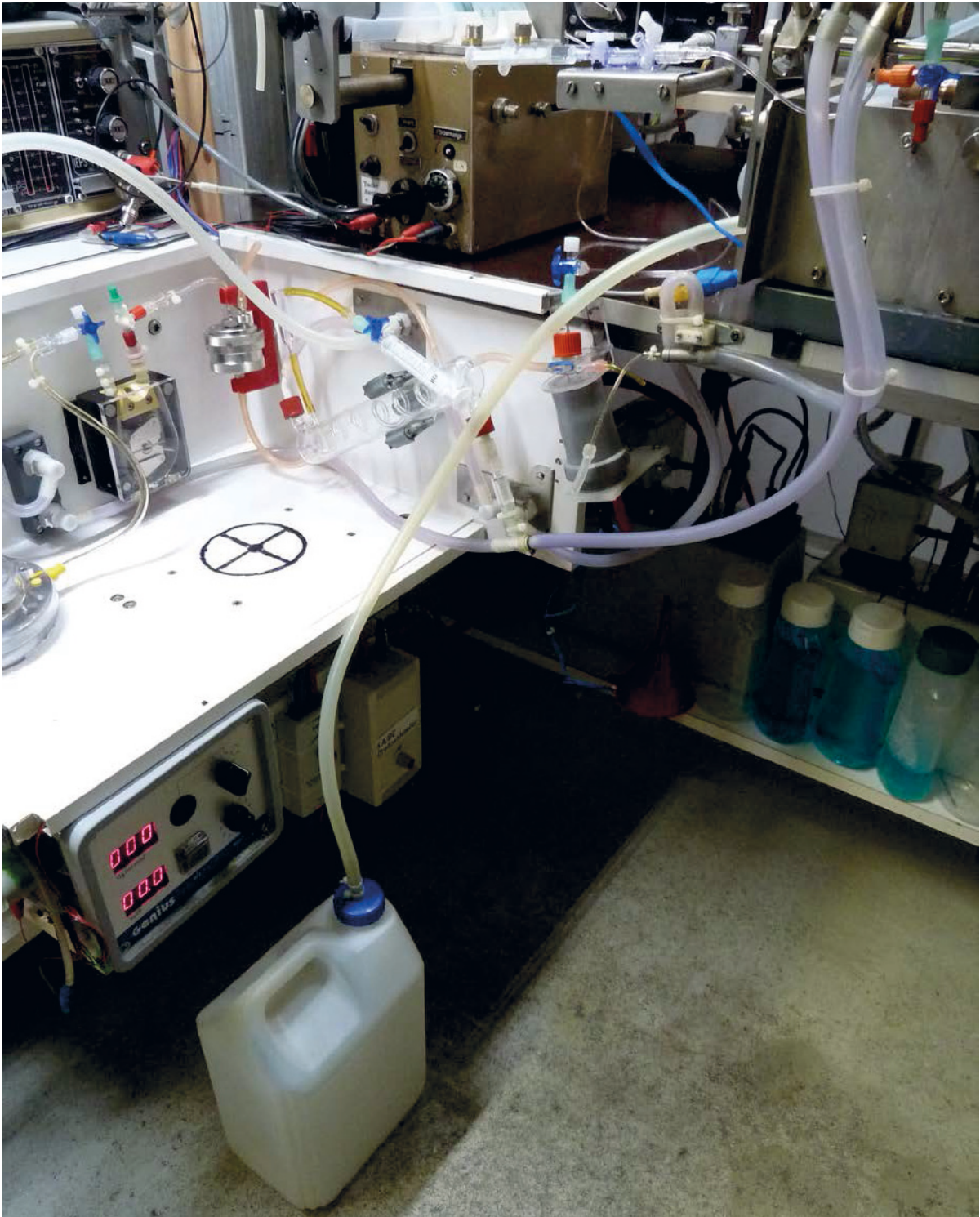
Abb. 5.1.2.5.: Effluatreservoir mit Zulaufschlauch. Links ist die Perfusionspumpe, das in-line Filter und die Glasschlange abgebildet, darüber im Goldtton die proportional steuerbare Zuinfusionspumpe, links unten Steuerungsmodul für den Einmischmagnetrührer und die Schlauchpumpe für die pO_2 -Messung.
