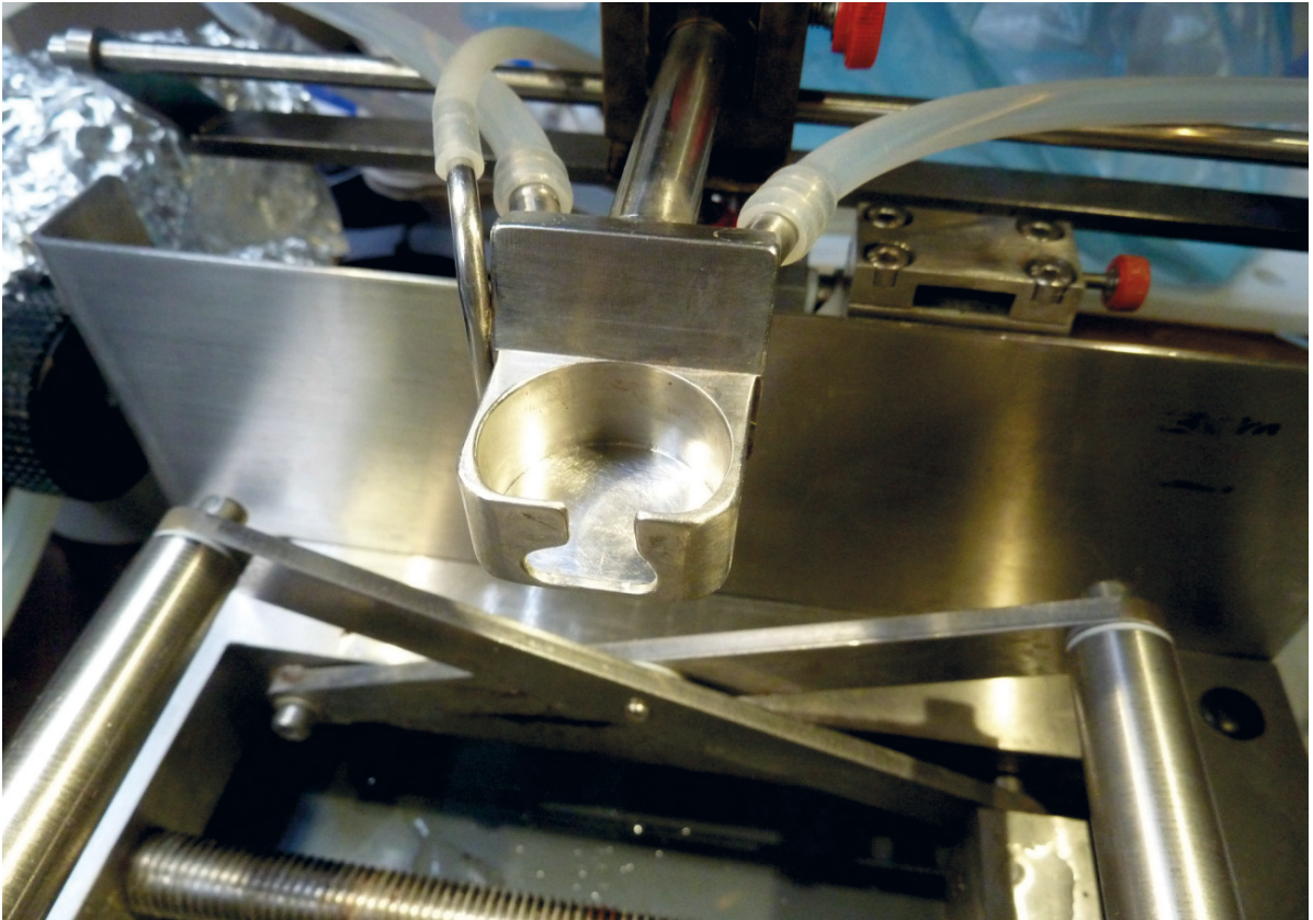
Abb. 8.1.1.7.: Aktuell eingesetzte, wasserbadtemperierte Nierenschale aus Edelstahl für die rechte Niere mit seitlichem Absaugröhrchen. Der asymmetrische Ausschnitt vorn berücksichtigt den Ureterabgang nach caudal. Die Wasserbadanschlüsse gehen über in einen U-förmigen Verlauf der Wasserführung im Rückenblock der Schale (Details s.a. techn. Anhang), sichtbar ist auch der Scherenlift für den OP-Tischeinsatz.
