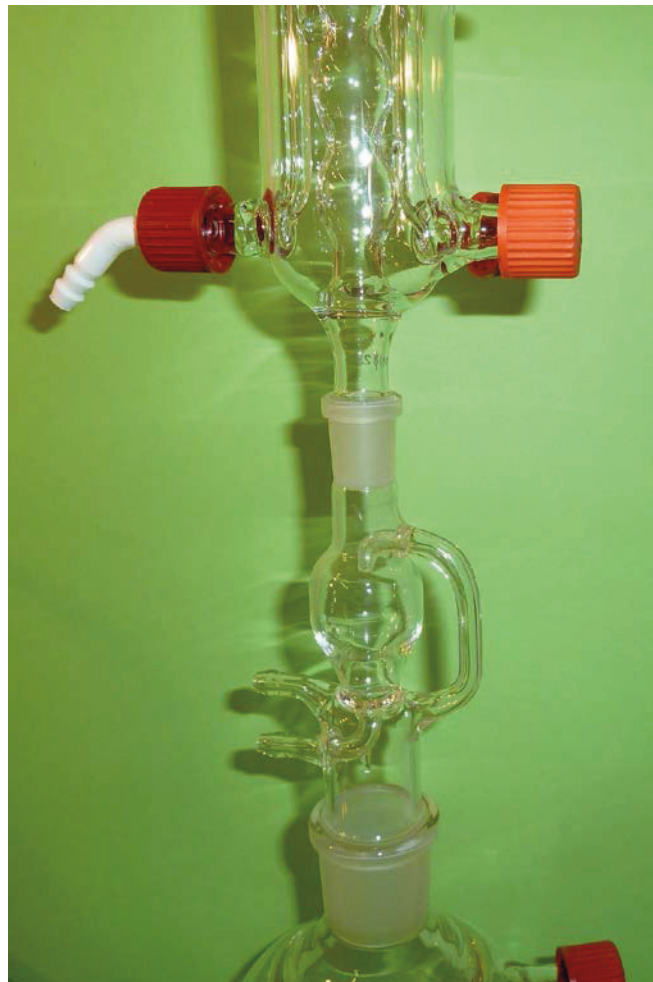
Abb. 4.2.4.: Glasoxygenator mit zugehörigem Reservoir, beide ummantelt für Wasserbad-Temperierung durch Umlaufthermostat, links unterbrochener Überlauf zum Ventileinbau für Überdruckeinspeisung. Rechts alternativer Übergang ohne Unterbrechung vom Oxygenator zum Reservoir (Design nach Schurek, unveröffentlicht).
