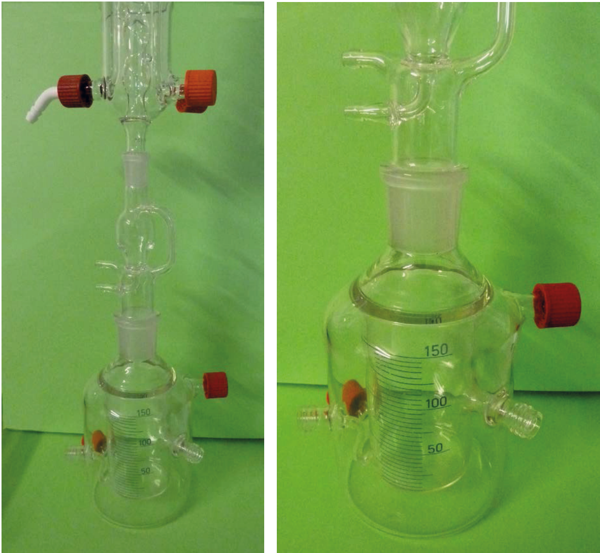
Abb. 4.2.5.: Reservoir mit Übergangsteil zum Glasoxygenator. Das Reservoir hat zwei mit Schraubkappen verschlossene Wasserbadanschlüsse. Links seitlich ohne Kappe der Anschluss zum Boden des Innengefäßes, rechts ohne Kappe der Anschluss für das Effluat vom Organ, sollte besser höher angesetzt sein, wie in Abb. 5.3.2.
