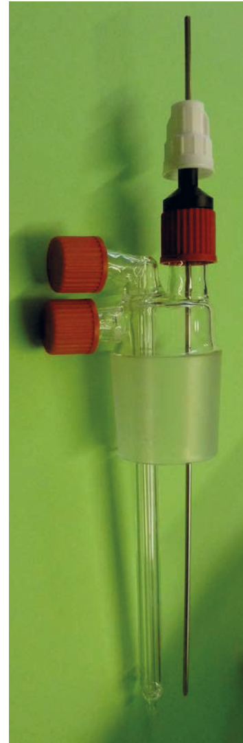
Abb. 5.3.2.: Doppelwand-Perfusatbehälter mit Rührmagnet , mit verstellbarem Füllstandsmeßstab und Doppelglasrohr für das Rezirkulat (Detail rechts), im zentralen Rohr wird das Aliquot für die Blutgasmessung zurückgeführt über ein eingestecktes Edeltahlröhrchen, das zudem Kontakt herstellt zum Perfusat für die elektronische Füllstandsregelung, die für die Perfusionsvariante Rezirkulation mit Dialyse genutzt wird (s.a. Abb. 5.2.3, dort ist das Röhrchen eingesteckt).
