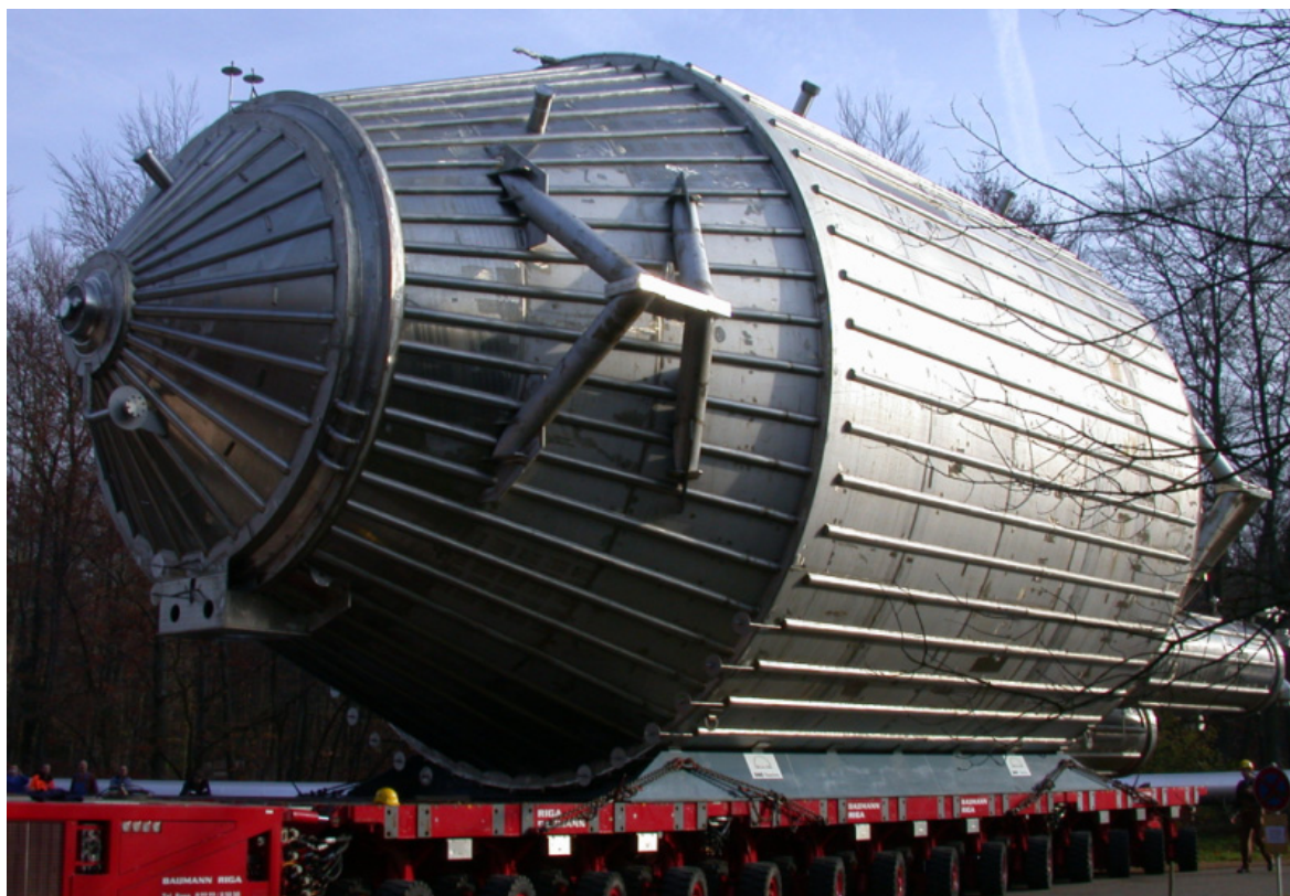
Abbildung 2.10: Hauptspektrometer Vakuumtank während des Transports. Dieses Foto zeigt den unverkleideten Vakuumtank des KATRIN-Hauptspektrometers während des Transports auf dem Gelände des Forschungszentrums Karlsruhe.
