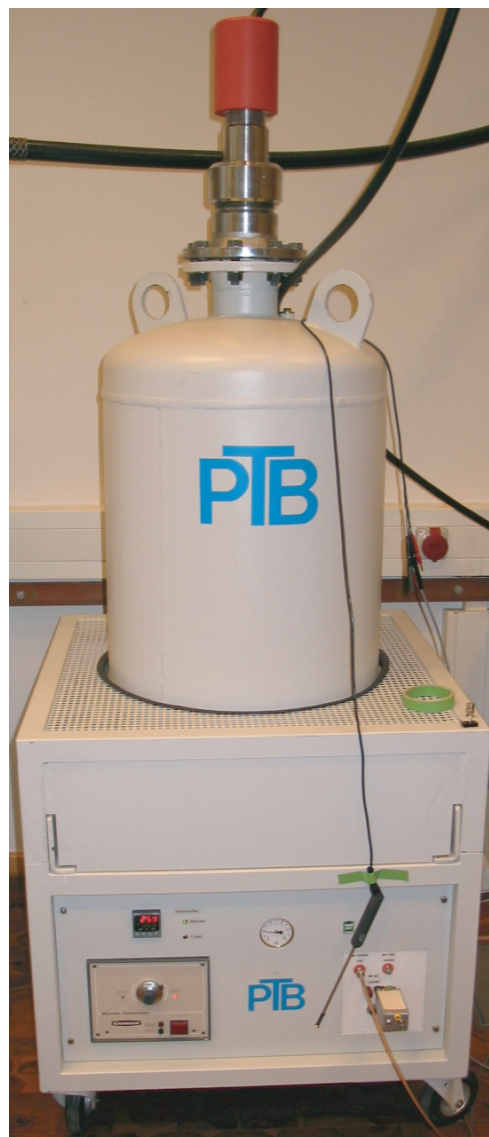
Abbildung 5.1: Referenzspannungsteiler MT100 der PTB. Diese Foto zeigt den etwa 1,6 m hohen 100 kV Referenzspannungsteiler (Bezeichnung: MT100) der Abteilung für Messwandler und Hochspannung der PTB Braunschweig.
