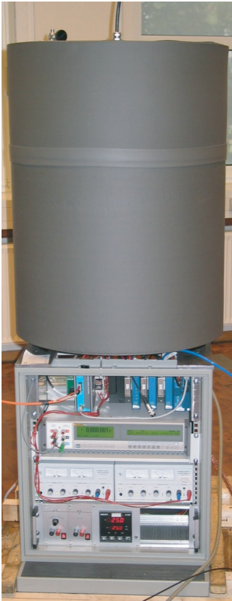
Abbildung 4.20: Fertiggestellter Spannungsteiler. Diese Foto zeigt den etwa 1,7 m hohen, fertiggestellten Aufbau des Spannungsteilers während der Testmessungen im Labor der PTB Braunschweig. Eine detaillierte Beschreibung der Kontroll- und Steuerkomponenten im Sockel des Aufbaus ist in Anhang D zu finden.
