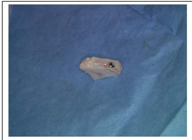
Abb. 8: Fertiger Probenblock mit Implantat
