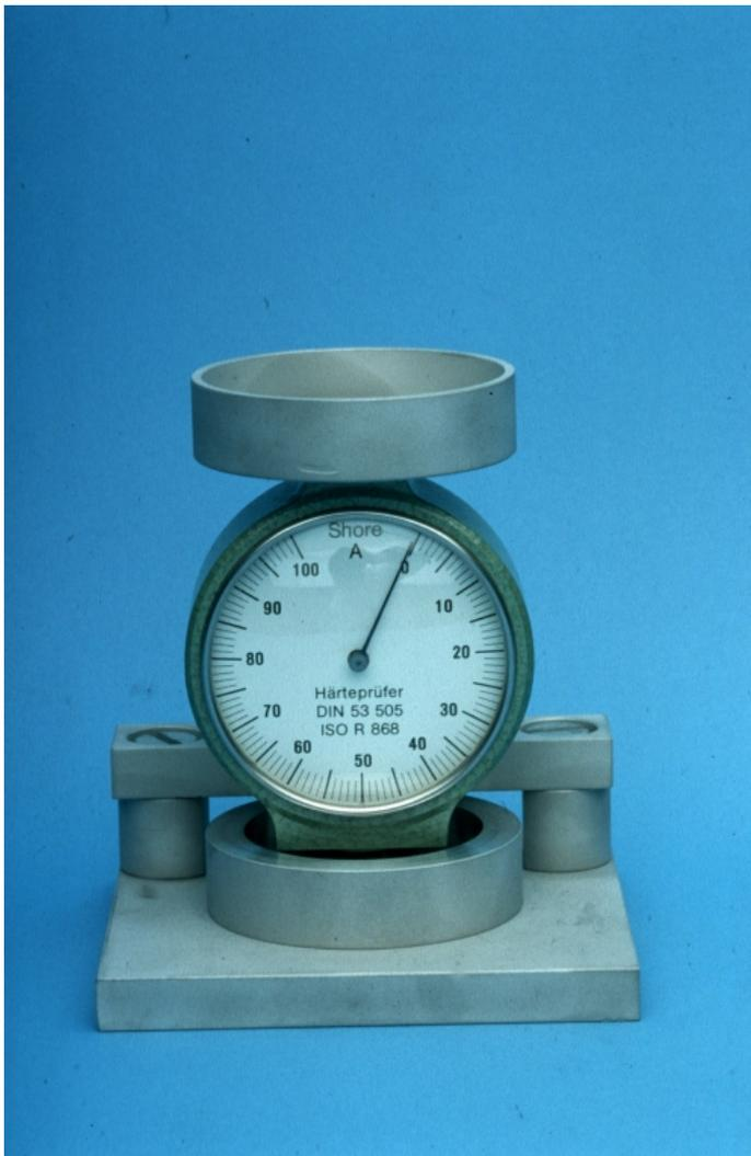
Abbildung 17: Härtemeßgerät in Führung integriert
