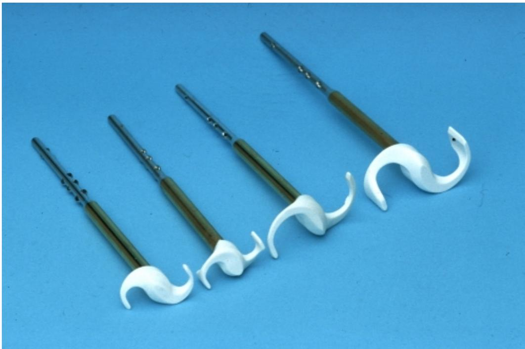
Abbildung 2: Mehrwegflügelrührer verschiedener Durchmesser und Höhen
