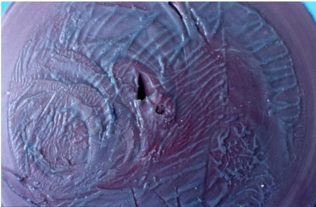
Abbildung 34: *Impregum F*, aus Krukenboden entfernt, mit nicht abreagierten Katalysatorresten
